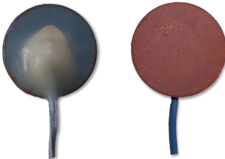
Figura 3.4.1. Fotoelectrodo terminado y listo para caracterización. A la izquierda se observa la parte trasera con el contacto y el cable soldado aislado, y a la derecha la superficie del fotoelectrodo.
