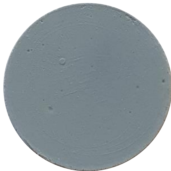
Figura 3.1.2. a) Perfil de temperatura utilizado para la sinterización de todos los substratos. b) Imagen cercana de un substrato 0.2%CuO-1% \text{Sb}_2\text{O}_5 -98.8% \text{SnO}_2 recién fabricado sin recubrimiento.
