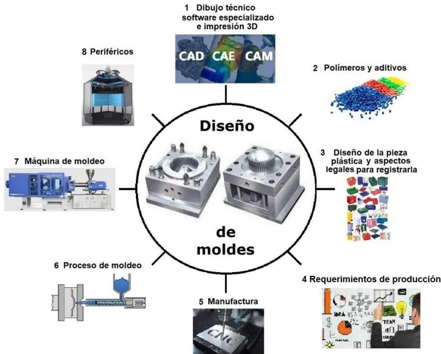
Fig. 4.4 Áreas que se deben conocer antes de iniciar el estudio de los fundamentos del diseño de un molde de inyección de colada fría, eficiente [1].
