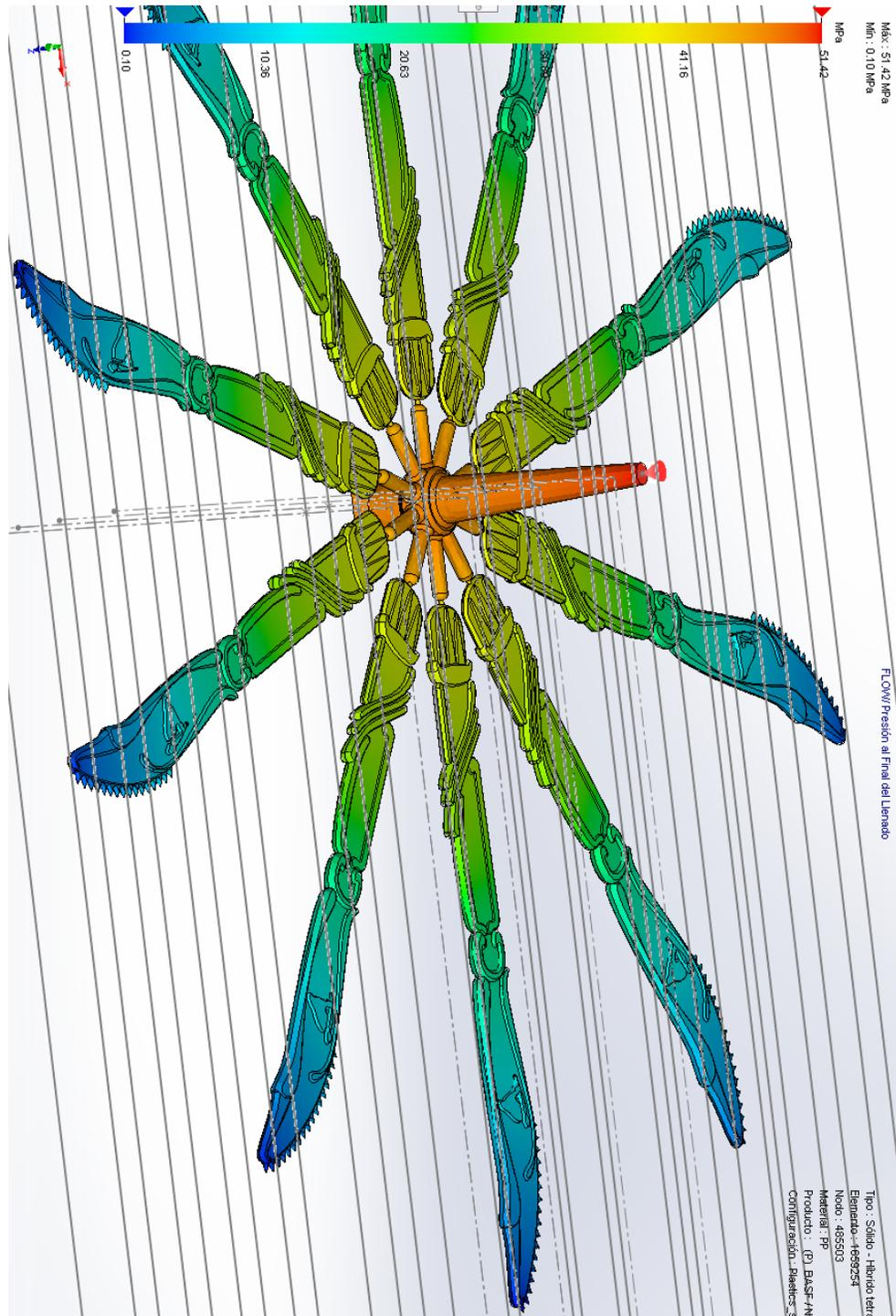
Fig. 4.115 Presión al final del tiempo de llenado de la pieza de moldeo.
