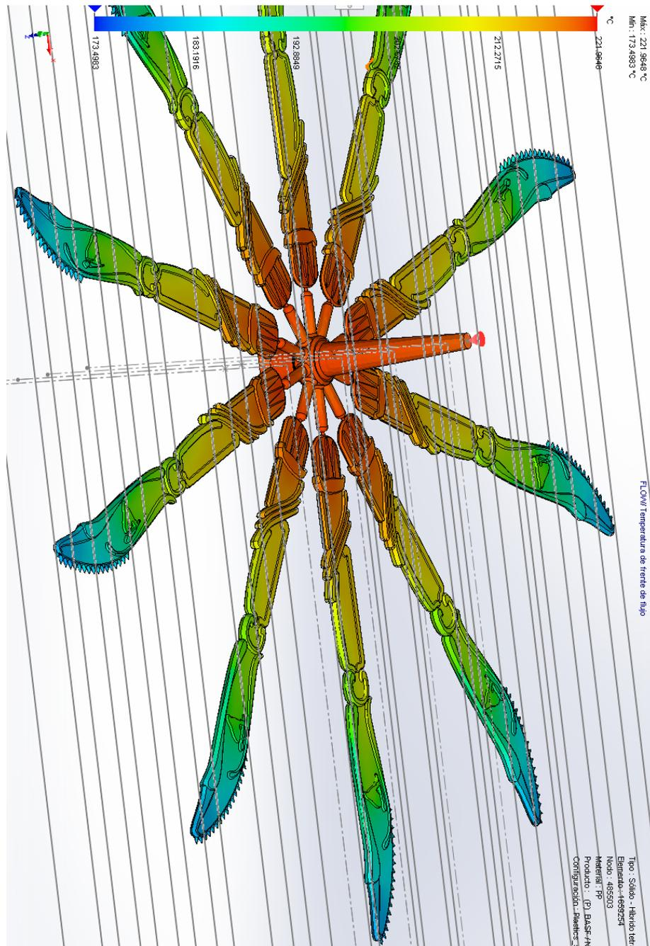
Fig. 4.117 Perfil de la temperatura de la pieza de molde, conforme se va llenando.
