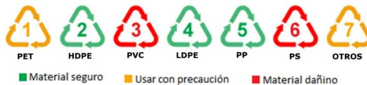
Fig. 3.5 Clasificación de los polímeros por su volumen de reciclaje y nivel de seguridad para plásticos en contacto con alimentos [11].
