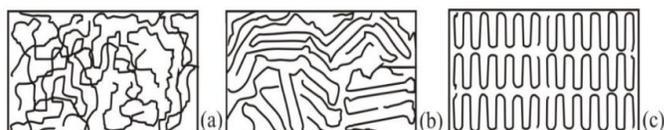
Fig. 3.2 Ordenamiento de las estructuras moleculares de los polímeros (a) amorfo, (b) semicristalino y (c) cristalino [10].
