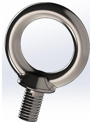
Fig. 4.73 Modelado 3D del cáncamo seleccionado, con las dimensiones del catálogo de SUMISI 2015.
