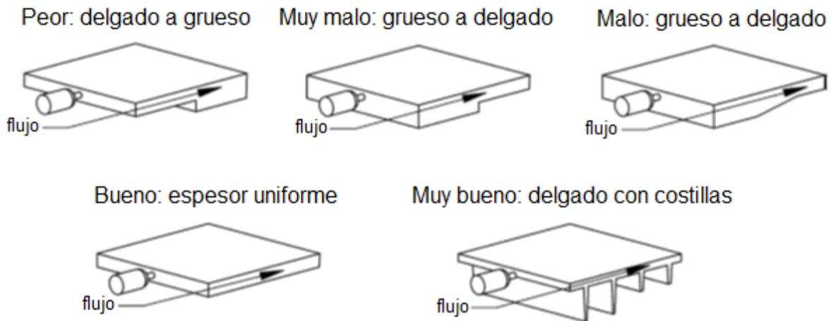
Fig. 3.12 Diseño de grosor de pared [25].
