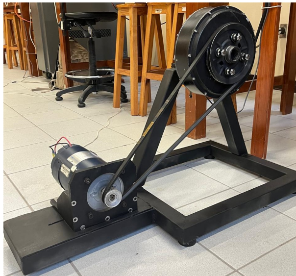
Figura 4.1: Base para el montaje del motor BLDC en rueda y motor CD para simular las condiciones de regeneración.
