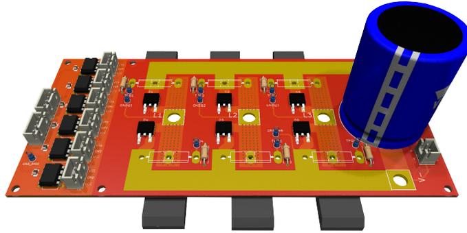
**Figura 4.12:** Vista en 3D del módulo inversor trifásico.
