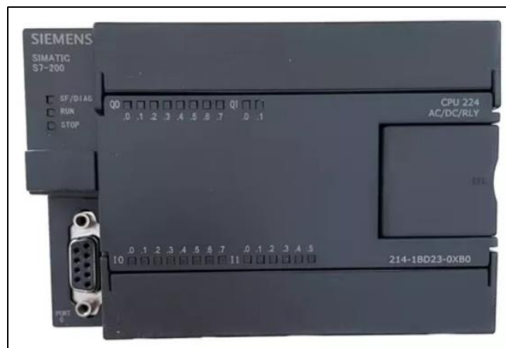
Figura 3.3: PLC S7-200 de SIEMENS, CPU 224.
