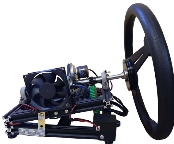
Figura 4.21: Resultado final de la construcción física del subsistema lado volante.
