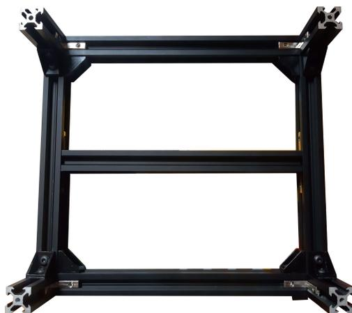
Figura 4.22: Ensamblaje físico del nivel inferior con los segmentos de soporte del SLR.
