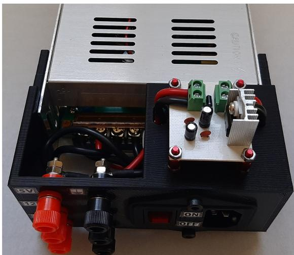
Figura 5.3: Adaptaciones en la fuente de alimentación conmutada.
