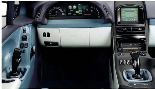
Figura 1.15: Vehículo Mercedes-Benz R129 con palancas laterales. Imagen tomada de la red en [29].
