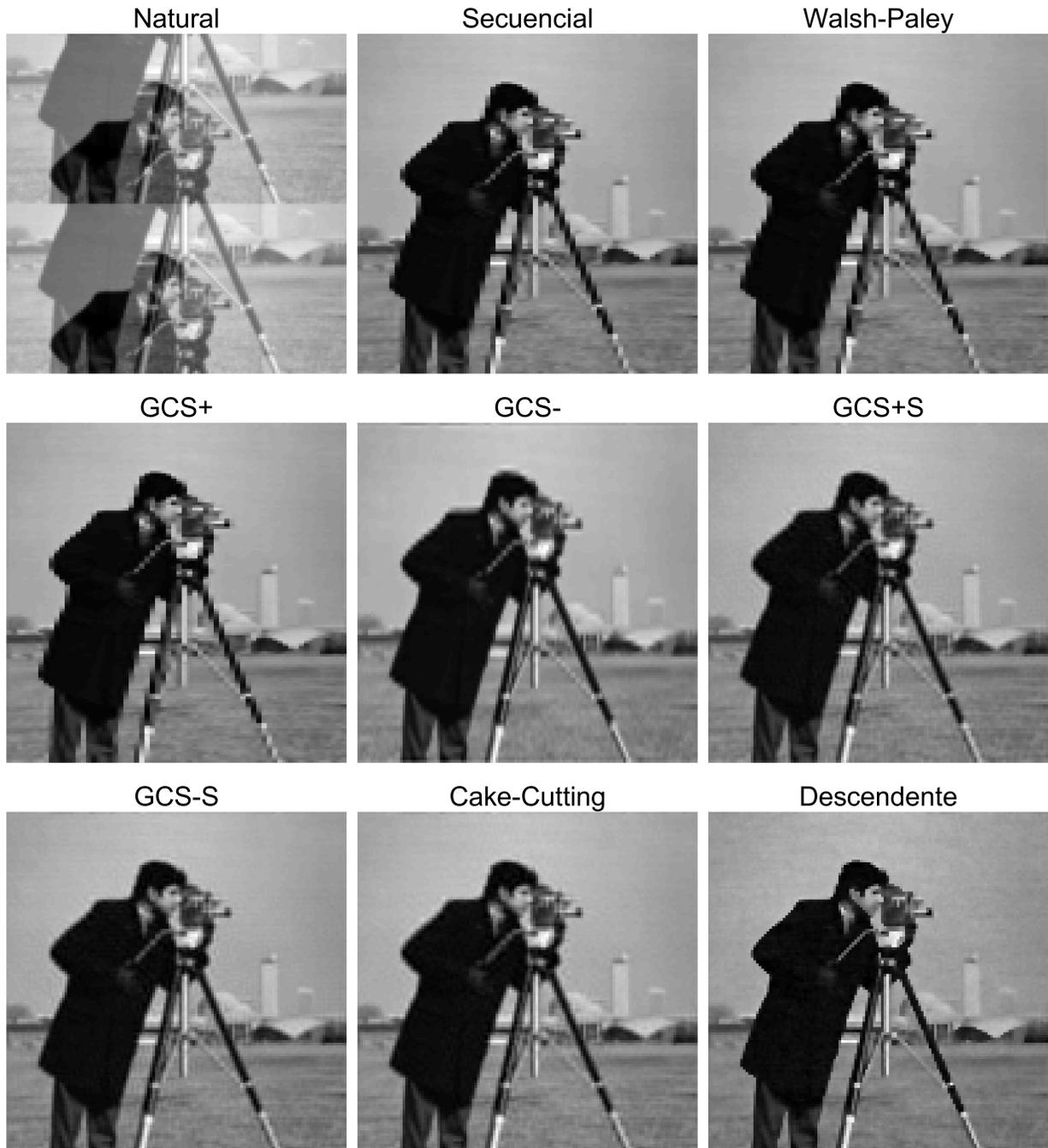
Figura 37: Reconstrucción de la imagen “cameraman” utilizando las matrices de los 9 ordenamientos y el algoritmo TVAL3, se muestran para una tasa de compresión del 50 %.
