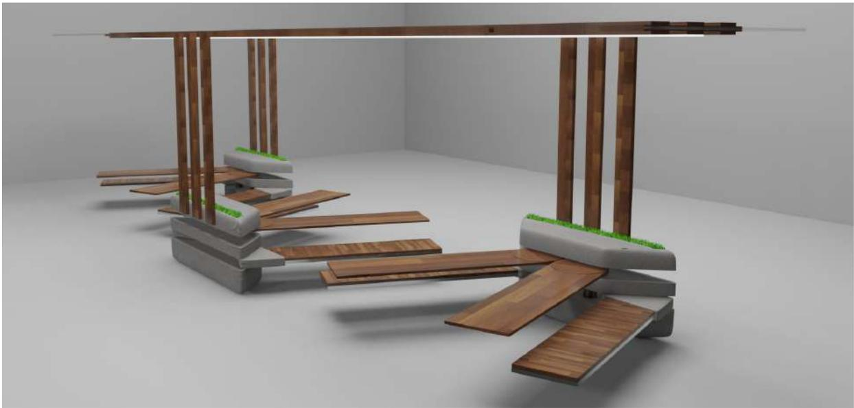
*Nota.* La mesa y las bancas giran sobre un eje para cambiar de posición y adecuarse a las necesidades de los usuarios.
