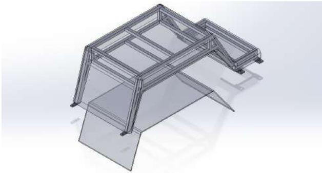
*Nota.* La figura muestra la ubicación de la pieza de PTR dentro de la pieza de resina y fibra de vidrio.
