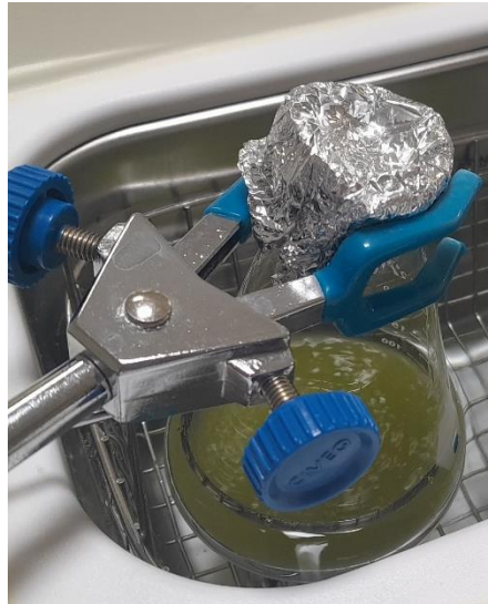
Figura 9. Extracción de aceite de palma ( Brahea dulcis ) por ultrasonido. 19
