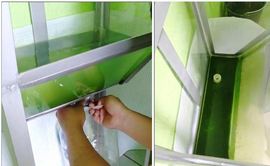
Figura 34. Separación de los lodos sedimentados y el agua residual.
