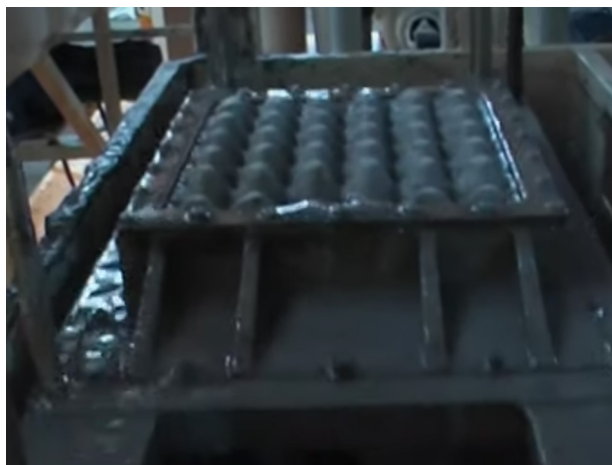
Figura 21 Obtención de la pulpa en molde. Fuente: Talleres Rosato S.A.
