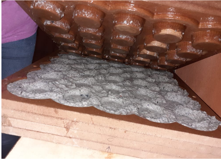
Figura 43 Desmoldeo del primer prototipo. Fuente: propia.
