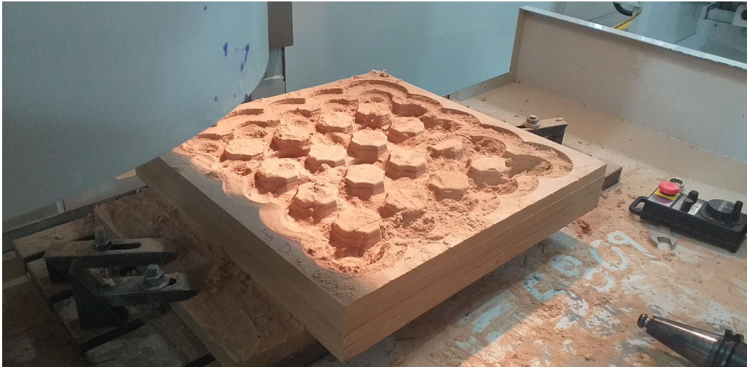
Figura 41 Maquinado de molde. Fuente: propia.
