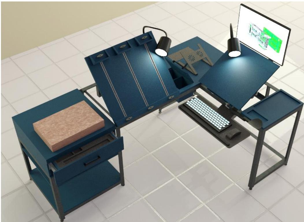
En lo que corresponde al módulo 1, se agregó una base por debajo del cajón de herramientas (Figura 91), para el caso en el que la pieza que se mide es grande y los topes se tengan que quitar, el usuario podrá colocarlos en dicha base.
