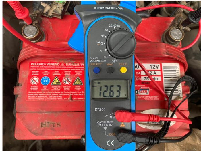
Figura 4.17. Voltaje de la batería.
