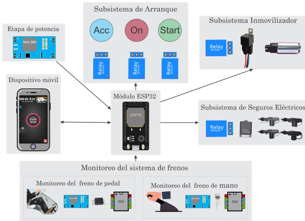
Figura 3.1. Diagrama general del SiSAV-Key.
