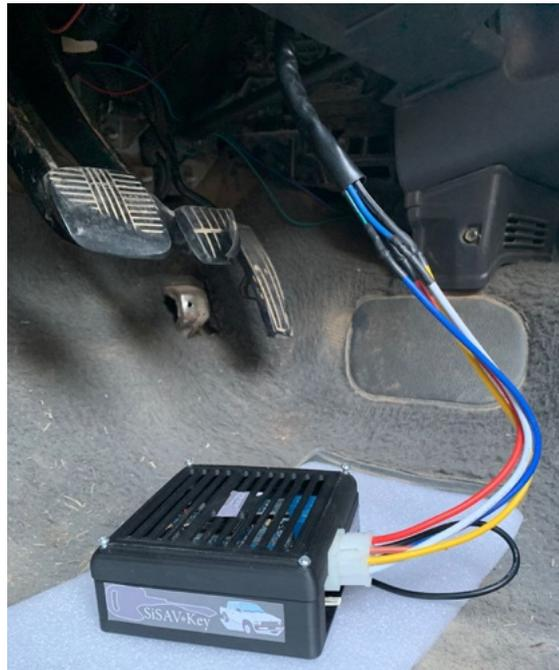
Figura 4.24. Instalación del SiSAV-Key.
