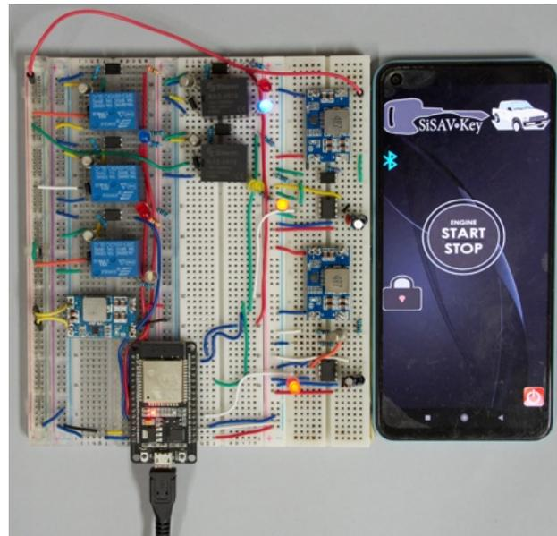
Figura 4.9. Subsistema de arranque apagado.
