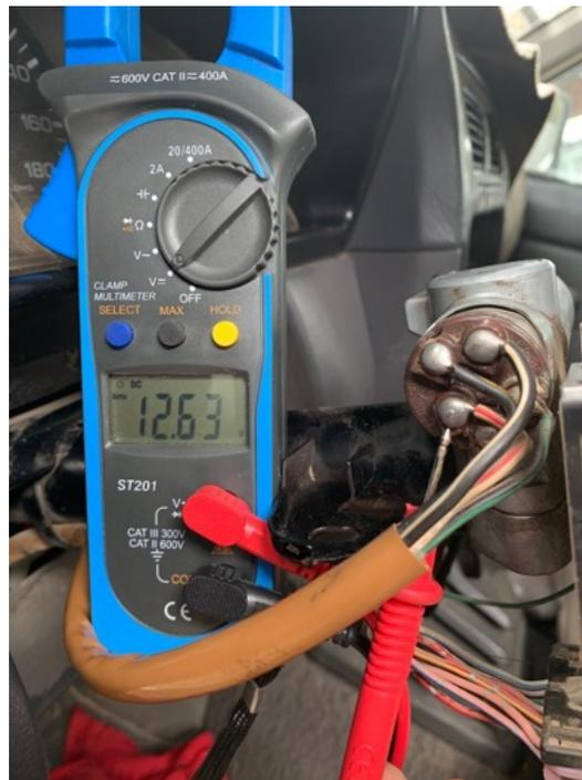
Figura 4.18. Voltaje medio en el interruptor de encendido.
