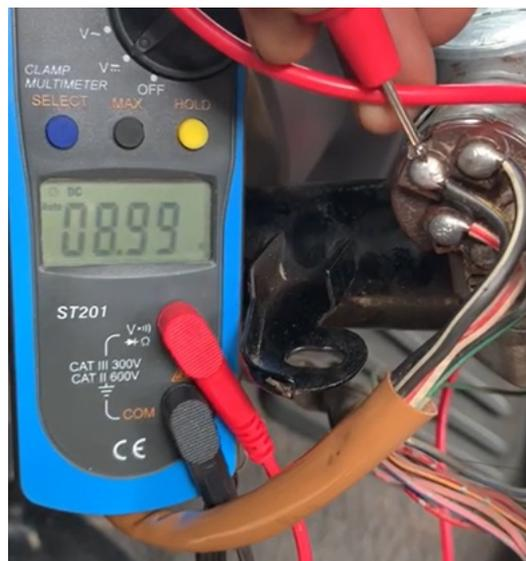
Figura 4.21. Voltaje al accionar la marcha.
