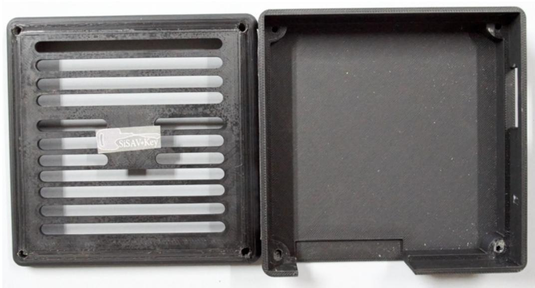
Figura C.1. Impresión 3D de la caja y tapa.
