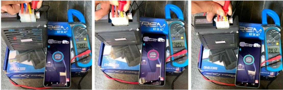
Figura 4.25. Voltajes de salidas para el sistema de arranque.
