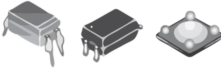
Figura 3.14. Encapsulados típicos de los optoacopladores (Floyd, 2008).
