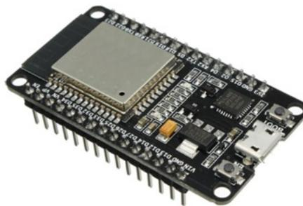
Figura 2.7. ESP32 de 30 terminales (Spanulescu, 2020).
