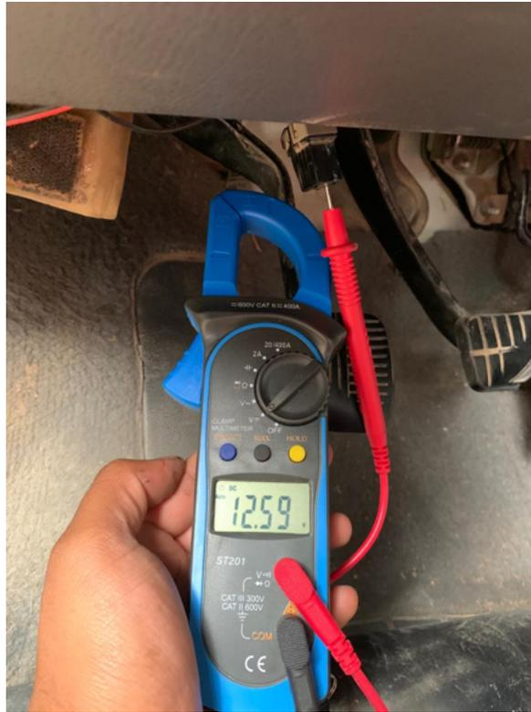
Figura 4.22. voltaje en el interruptor del freno de pedal.
