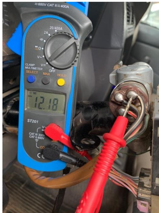
Figura 4.20. Voltaje al accionar el sistema de ON.
