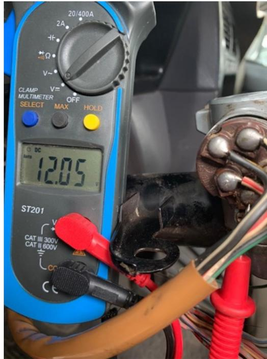
Figura 4.19. Voltaje al accionar el sistema de accesorios.
