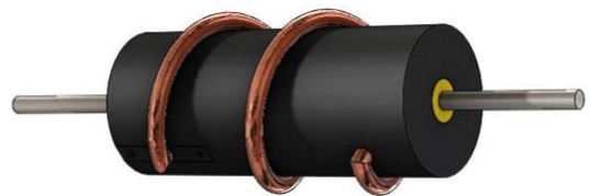
(b) Implementación del inersor de fluido magnetoreológico [3].
