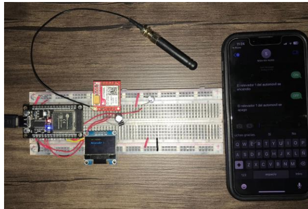
Figura 4.6. Mensaje SMS de notificación del encendido y apagado del relevador.
