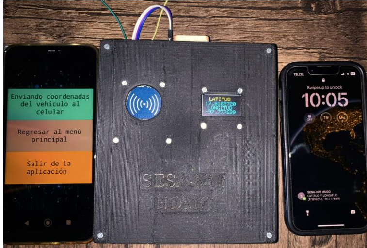
Figura 4.19. Envío y recepción de las coordenadas GPS.
