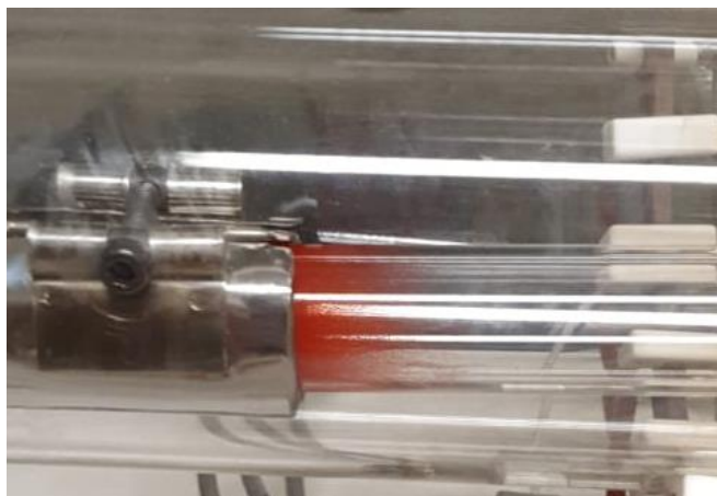
Figura 22. Material precursor precipitado inmediatamente después de su calefactor.
