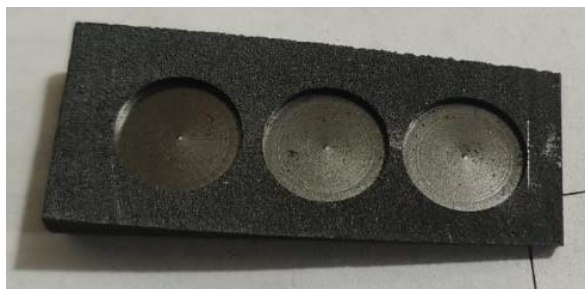
Figura 23. Cuña 4. Con una inclinación de 8°, una longitud de 5 cm y una separación de 2 mm entre cada uno de sus 3 cavidades de 1.2 cm de radio.
