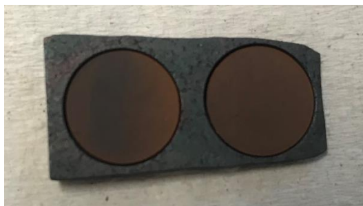
Figura 13. Depósito S67, fue utilizada la cuña 1, misma que sería utilizada de manera continua hasta el depósito P10. La densidad de fotocorriente obtenida fue de 4.42 \text{ mA/cm}^2 .
