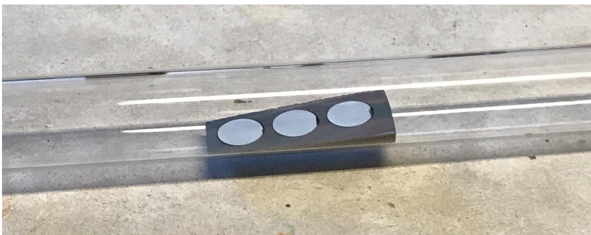
Figura 11. Portasustratos con sustratos cerámicos dentro del tubo interior del reactor de CVD.
