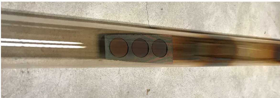
Figura 12. Sustratos cerámicos después de un depósito de hierro.
