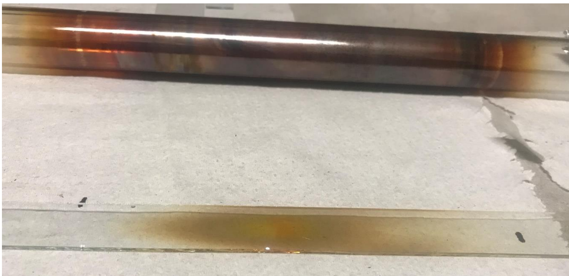
Figura 21. Depósito sobre vidrio. La longitud del vidrio comprendía desde el crisol con el polvo precursor, pasando por la zona de depósito, hasta cerca del final del reactor.
