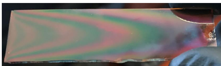
Figura 20. Depósito de hierro sobre vidrio. Se pueden apreciar zonas con geometría de "lenguas" de diferentes tonalidades, presumiblemente debido a variaciones en el grosor del depósito de hierro sobre la superficie
