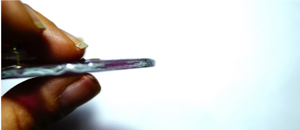
Figura 122. Redondeo de bordes mediante vitrofundición. Fuente: Autoría propia, 2023.
