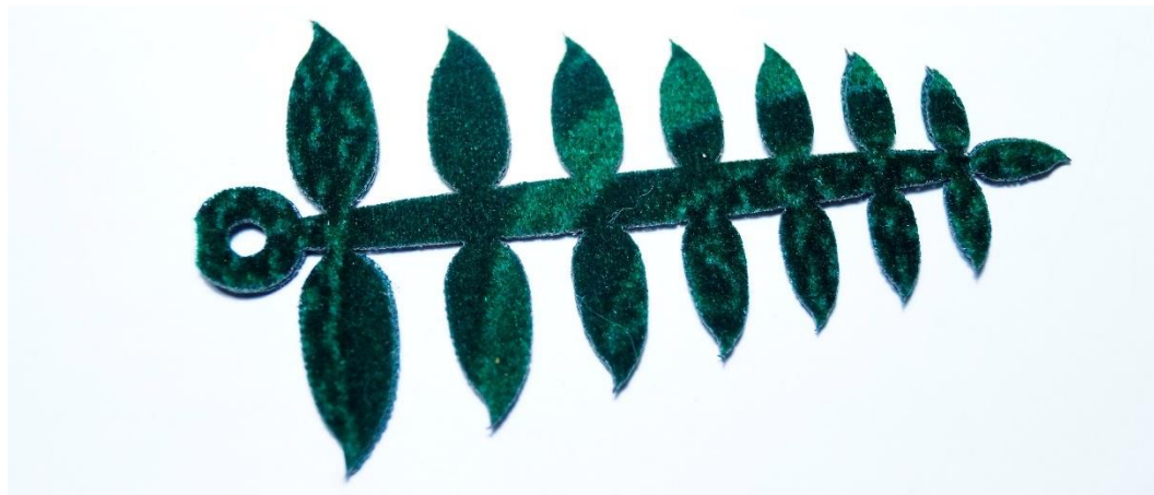
Figura 124. Corte láser en textiles de fibras sintéticas. Fuente: Autoría propia, 2023.
