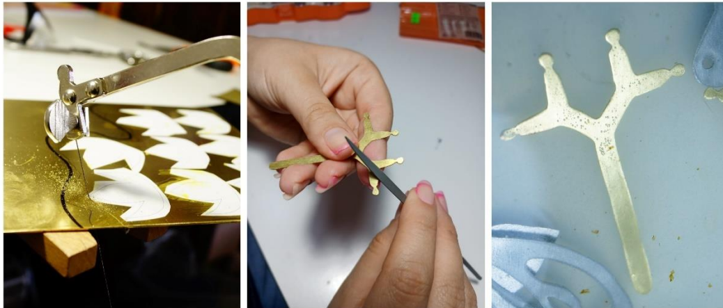
Figura 118. Proceso de calado en lámina de latón. Fuente: Autoría propia, 2023.
