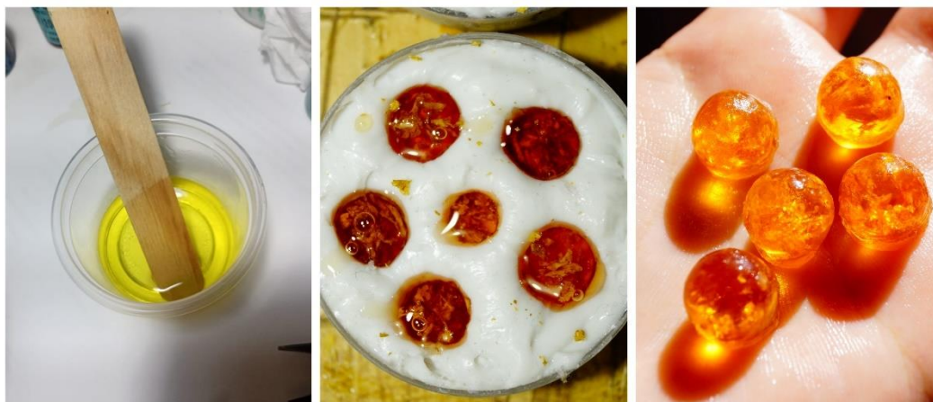
Figura 117. Proceso de encapsulado de especies vegetales en resina. Fuente: Autoría propia, 2023.
