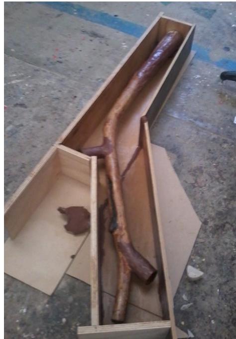
Figura 86 Fabricación del molde para los componentes de ramas terciarias
