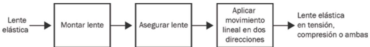
Figura 3.13. Secuencia de la lente elástica aislada de la descomposición del diagrama funcional de la montura optomecánica.
