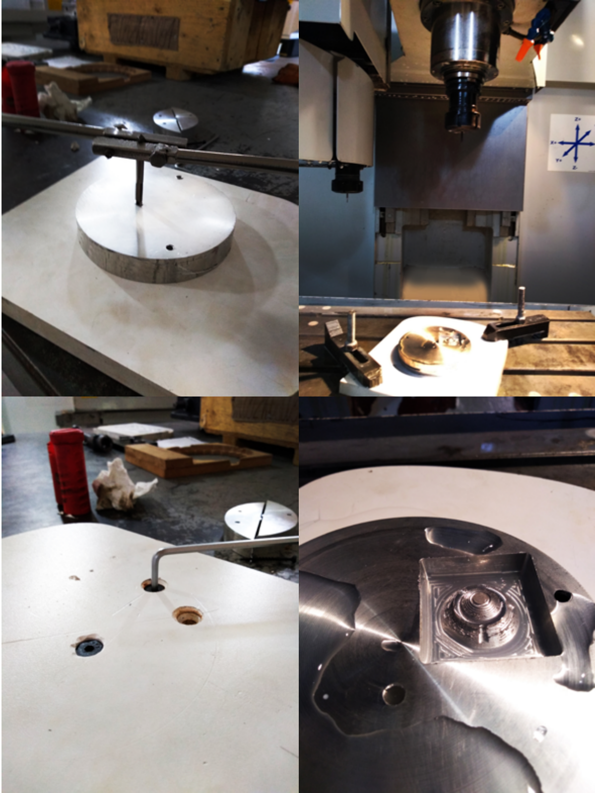
Figura 5.6. Montaje de material para maquinar y primeros cortes.
