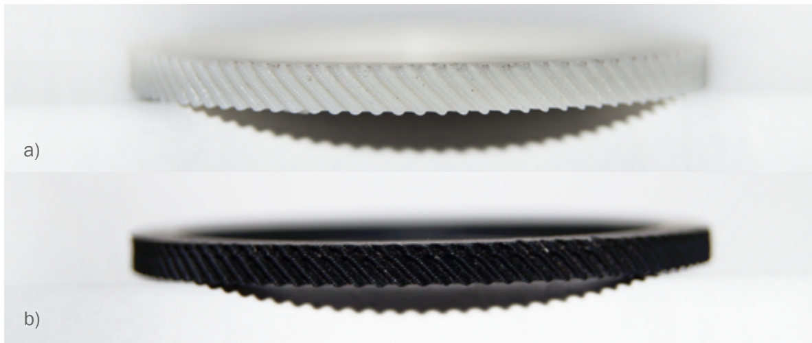
Figura 5.1. Pruebas de impresión de engrane: (a) impreso en ABS y (b) impreso en PLA.
