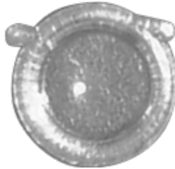
Figura 1.6. Superficie de refracción con un diámetro de 10 mm. Fuente: Cruz-Felix, y et al. 2015.
