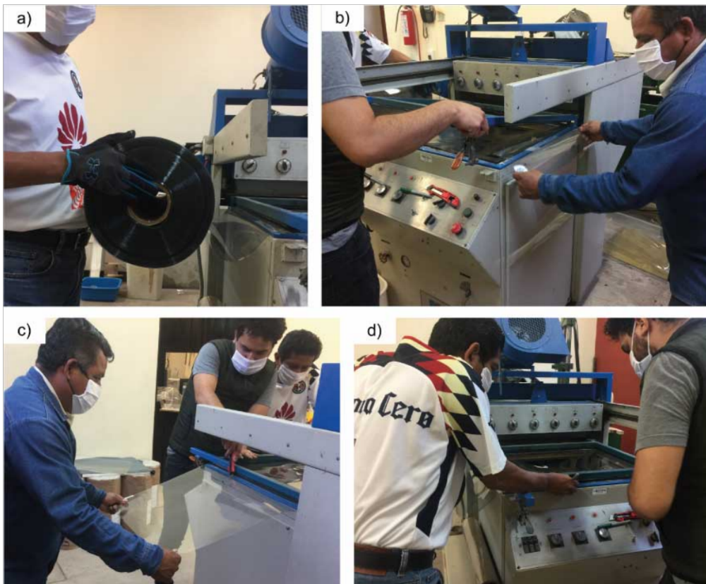
Figura 2 Proceso del corte de secciones de lámina de PET.
