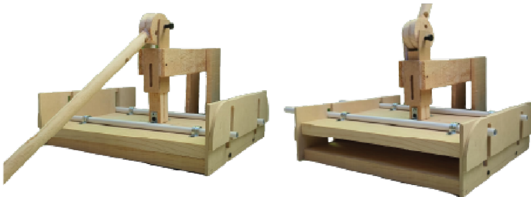
Figura 65 Prototipo de prensa con mecanismo de leva-seguidor.
