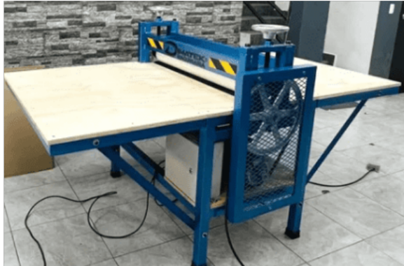
Figura 41 Tercer modelo de máquina suajadora eléctrica.
