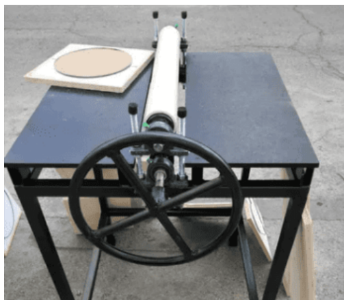
Figura 37 Tercer modelo de máquina suajadora manual.
