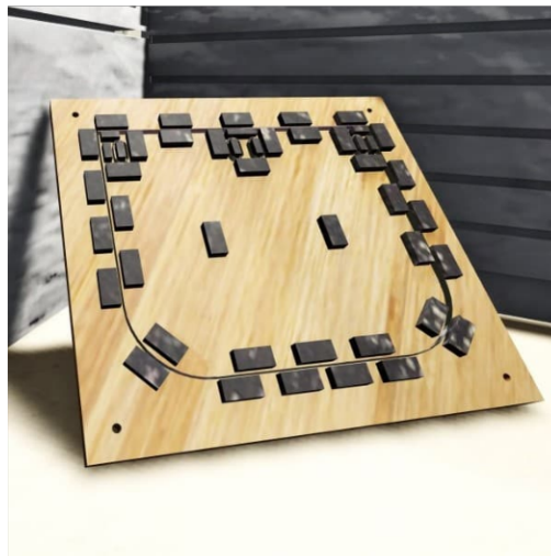
Figura 79 Diseño conceptual de suaje.
