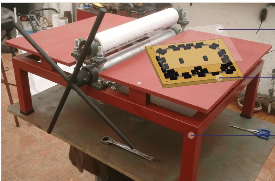
Figura 80 Suaje montado en la máquina seleccionada.
