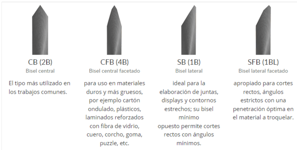
Figura 27 Tipos de biselado de los flejes de corte.
