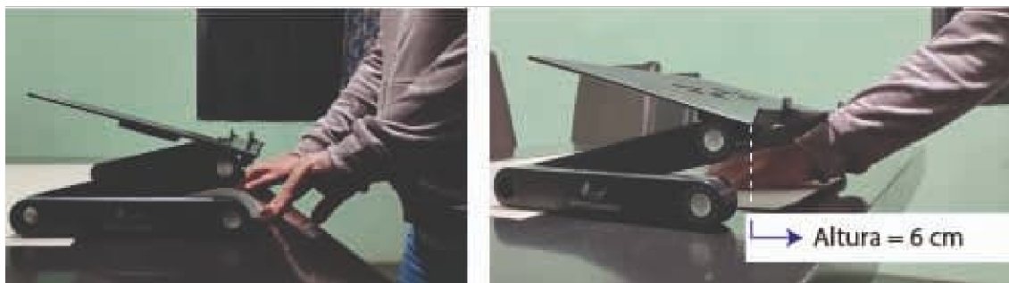
Figura 76 Prueba para determinar la altura a salvar con el mecanismo de leva.
