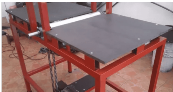
Figura 39 Primer modelo de máquina suajadora eléctrica.
