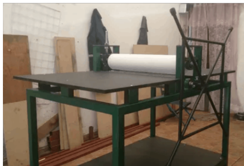
Figura 38 Cuarto modelo de máquina suajadora manual.
