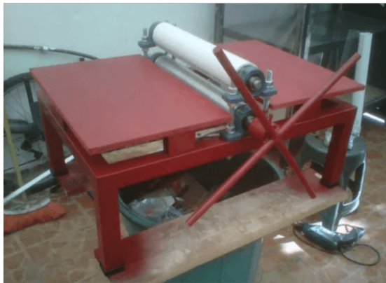
Figura 35 Primer modelo de máquina suajadora manual.
