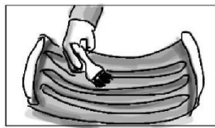
Aplicación de gelcoat a la pieza.
