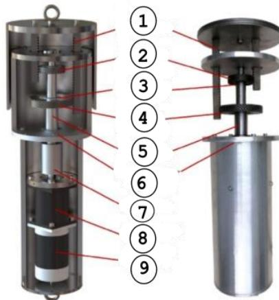
**Figura 2.17** Estructura del AR electromecánico basado en cremalleras y engranes helicoidales. 1) cremallera helicoidal, 2) engrane helicoidal para producir rotación horaria, 3) embrague unidireccional, 4) engrane helicoidal para generar rotación antihoraria, 5) eje de accionamiento, 6) placa circular inferior, 7) acoplador mecánico, 8) caja de engranajes planetarios y 9) el generador eléctrico [54].
