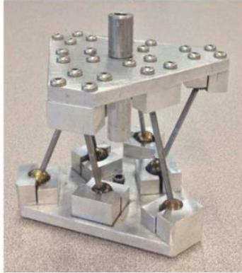
*Figura 2.14 Prototipo del mecanismo tipo tornillo algebraico [46].*
