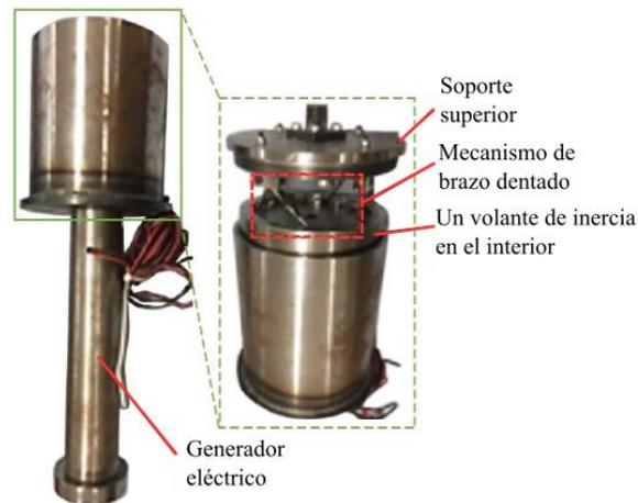
**Figura 2.15** Prototipo del AR electromecánico basado en el mecanismo tipo brazo dentado de accionamiento indirecto [3].
