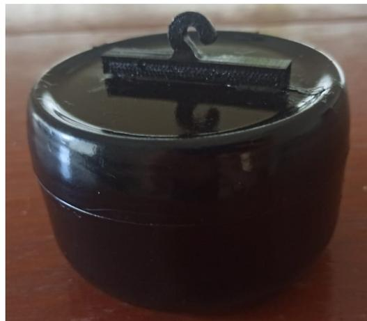
Figura 4.12: Masa con adaptación para el soporte.
