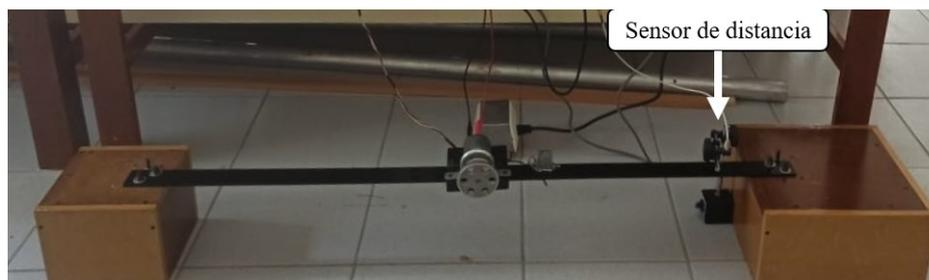
Figura 5.10: Sensor de distancia implementado en el sistema.
