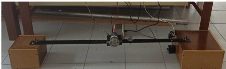
Figura 4.22: Sistema con viga en empotramiento doble.
