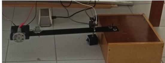
Figura 4.21: Sistema con viga en voladizo.
