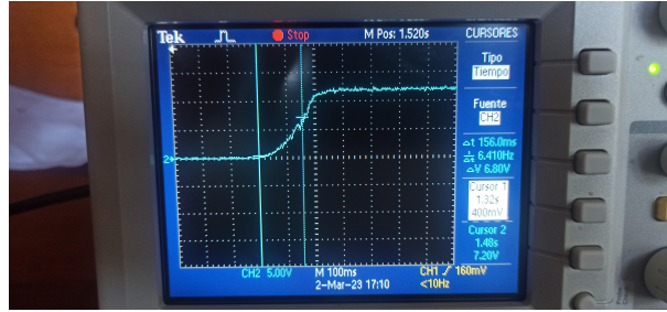
Figura D.9: Cálculo de la constante de tiempo de estabilización mecánica constante de estabilización mecánica, por lo tanto, t_m=0.039s .
