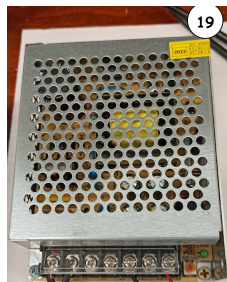
Figura D.7: Alimentación del sistema: Fuente de 12V DC a 10 A
