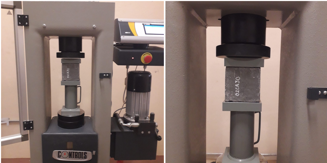
(a) Colocación de la probeta.
