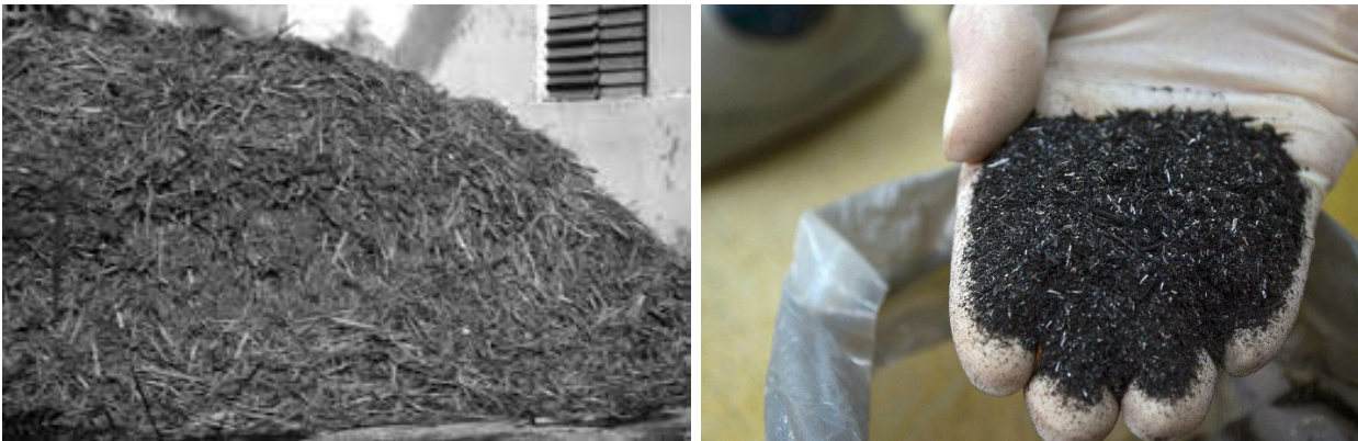
Figura 4 Almacenamiento a granel de la ceniza de caña. Fuente: Triana et al., 2014.
