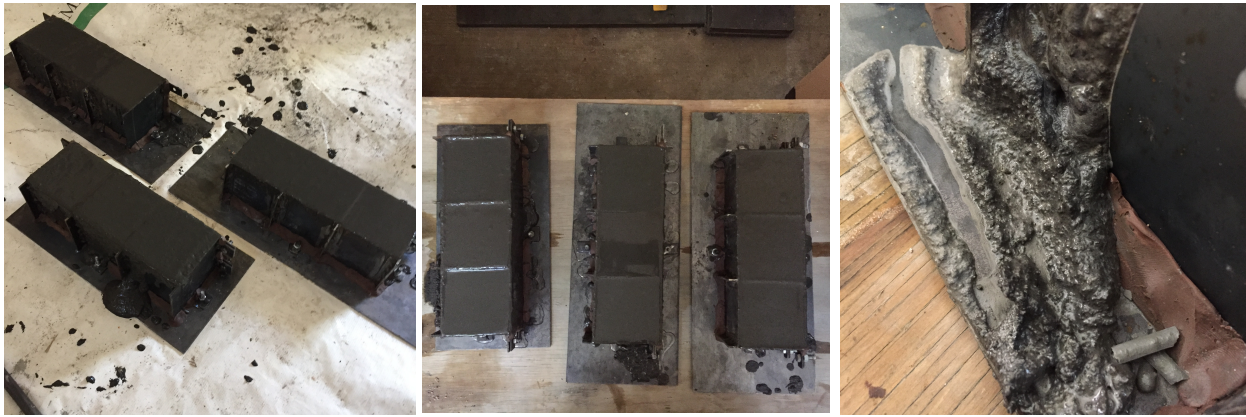
(a) Vaciado de la mezcla 06CBA30. (b) Moldes de acero colocados para su fraguado. (c) Consistencia de la mezcla 06CBA30.
