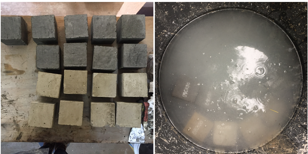
(a) Probetas 06CBA30 y patrón desmoldadas. (b) Probetas 06CBA30 y patrón sumergidas.
