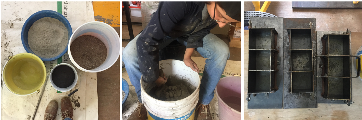
(a) Cemento Portland, CBA, (b) Elaboración manual de (c) Moldes de acero armados y agregados y agua. mezcla. engrasados.
