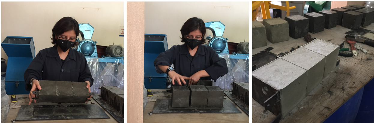
(a) Desmolde de las probetas 06CBA30. (b) Desmolde de las probetas 06CBA30. (c) Molde desarmado y probetas desmoladas.
