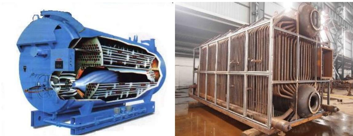
*Nota.* Interiores de diferentes tipos de calderas, resaltando sus tubos en donde circula el agua.
