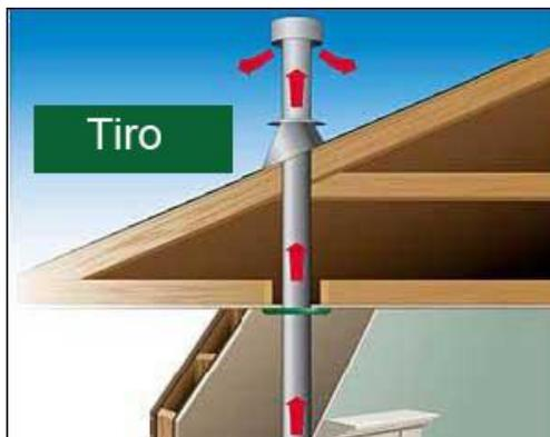
*Nota.* Ilustración con una corriente vertical y con salida horizontal gracias a la chimenea.
