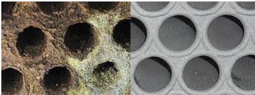
*Nota.* Corrosión interna (izquierda) y corrosión externa (derecha).
