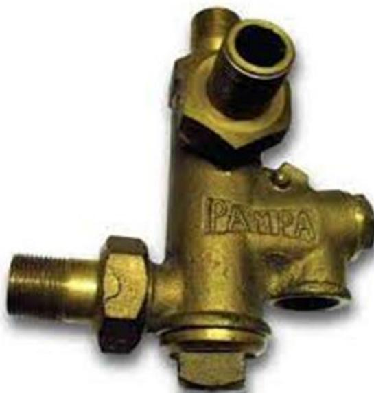
*Nota.* Ejemplo de un inyector, para introducir agua en el hogar de la caldera.
