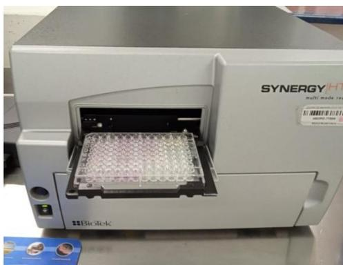
**Figura 26.** Lector de microplacas utilizado en este estudio
