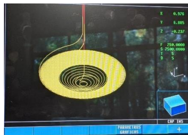
Figura 3.6. Trayectoria que sigue el cortador en tiempo real y que se puede visualizar de forma virtual.
