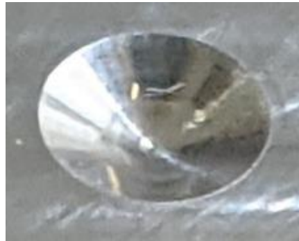
Figura 3.8. Maquinado final del perfil esférico con un diámetro de 4 milímetros.
