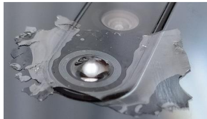
Figura 3.14. Forma en la que se coloca la lente en la parte trasera del teléfono inteligente.
