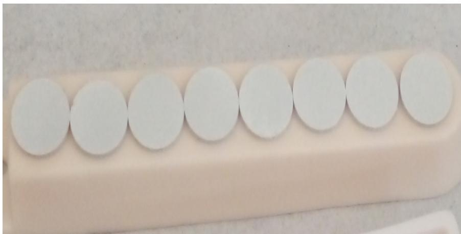
*Figura 39: Discos con radio de 6 mm, altura de 1mm de la mezcla de  $\text{SnO}_2$ ,  $\text{Sb}_2\text{O}_5$  y  $\text{MoO}_3$ .*
