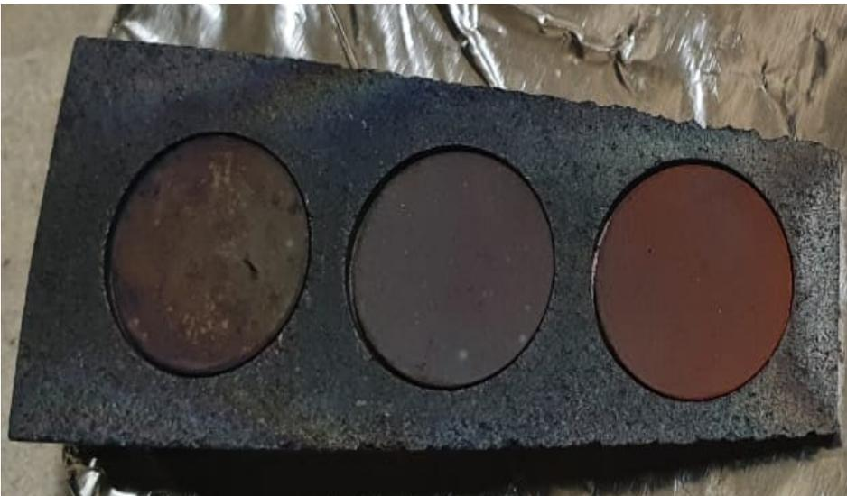
*Figura 36: Muestra P<sub>149</sub> sobre cuña 4, en el substrato de en medio se puede notar un exceso de carbón, sin embargo, este desaparece después del tratamiento térmico.*
