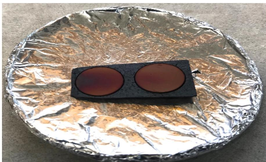
*Figura 23: Inhomogeneidad en la muestra P<sub>34</sub>. Se puede observar la aparición de una sombra al medio de los depósitos.*
