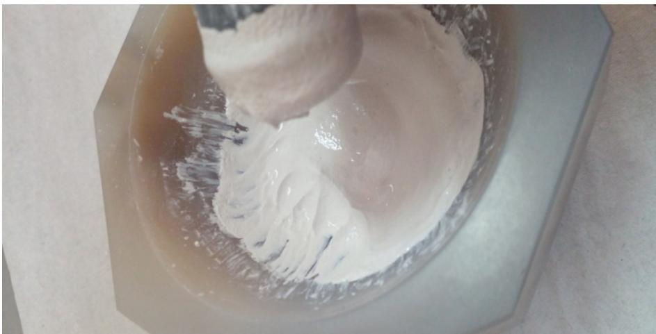
Figura 38: Mortero de ágata con mezcla de polvos de  $\text{SnO}_2$ ,  $\text{Sb}_2\text{O}_5$  y  $\text{MoO}_3$  y agua destilada.
