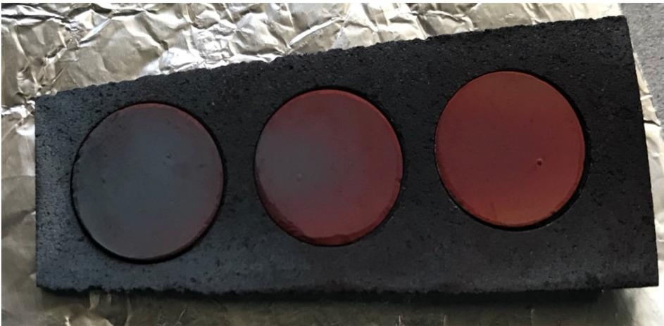
*Figura 30:  $P_{90}$  depositadas sobre cuña 4, como en el caso anterior se puede apreciar la inhomogeneidad a lo largo de la parte central de las muestras.*
