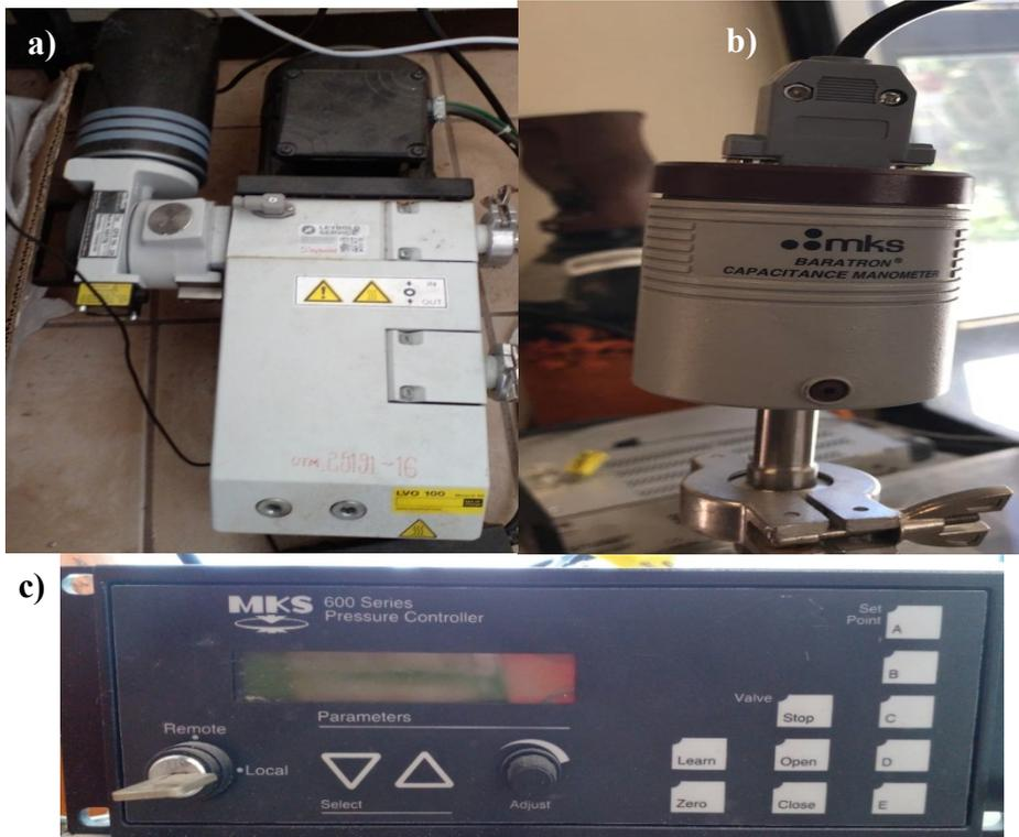
Figura 18: a) Bomba de vacío de paletas rotativas TRIVAC D 16-65 BCS, b) Baratrón de capacitancia (BARATRON MKS 626A12TDE), c) Controlador de presión MKS 600 series.
