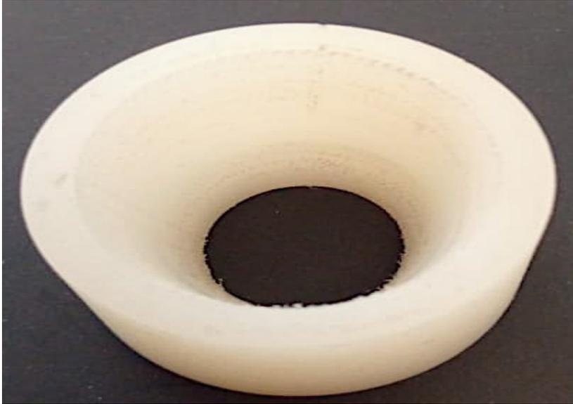
*Figura 26: Boquilla cónica, cuyo propósito era suavizar el cambio de la sección transversal entre la entrada del flujo de gas de arrastre y el tubo confinador de reacción.*
