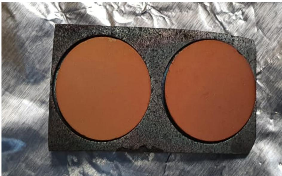
*Figura 33: Muestra P<sub>105</sub> sobre cuña 5. Se aprecia un recubrimiento homogéneo.*
