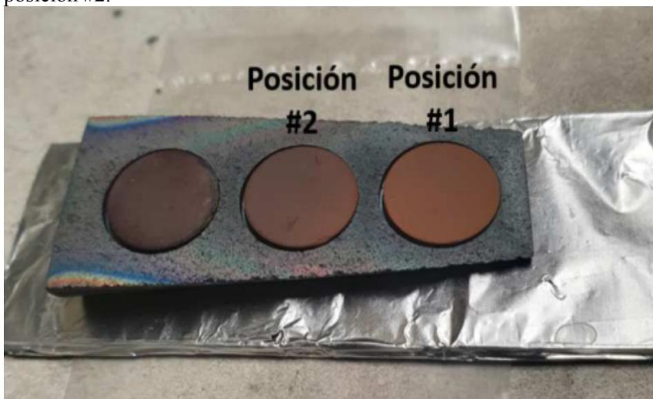
Figura 52: Cuña 4 usada durante el depósito del precursor de hematita.
