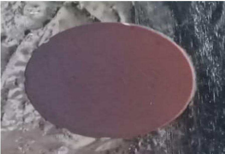
*Figura 20: Muestra  $P_1$ , Recubrimiento no homogéneo sobre la superficie de la muestra.*
