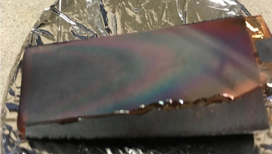
*Figura 31: Vidrio 5 en cuña 4, sobre el vidrio se puede apreciar el patrón en el que se estaba depositando el material precursor, se pueden observar regiones más oscuras y claras en forma de lengua.*
