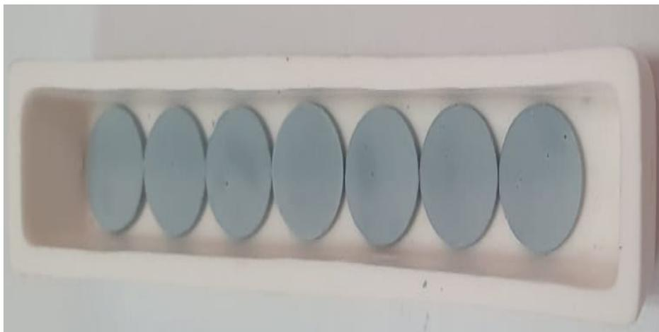
*Figura 40: substratos cerámicos de  $\text{MoO}_3\text{-Sb}_2\text{O}_5\text{-SnO}_2$ .*
