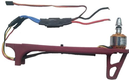
Figura B.3: Extensión del cableado del motor.
