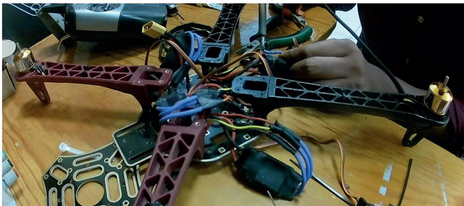
Figura B.4: Soldando el ESC al motor.
