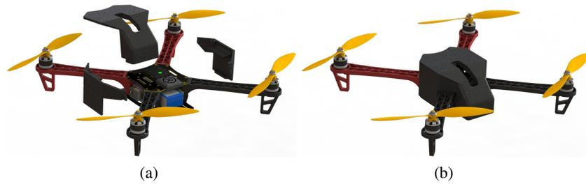
Figura 3.7: Vista explosionada de la carcasa
