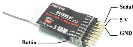
Figura B.5: Pines del receptor R8EH.
