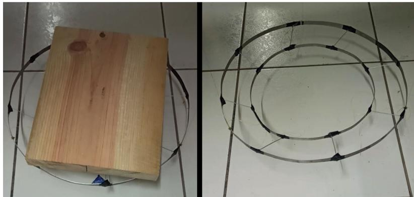
Figura C.13: Pruebas en el péndulo trifilar con y sin la madera.
