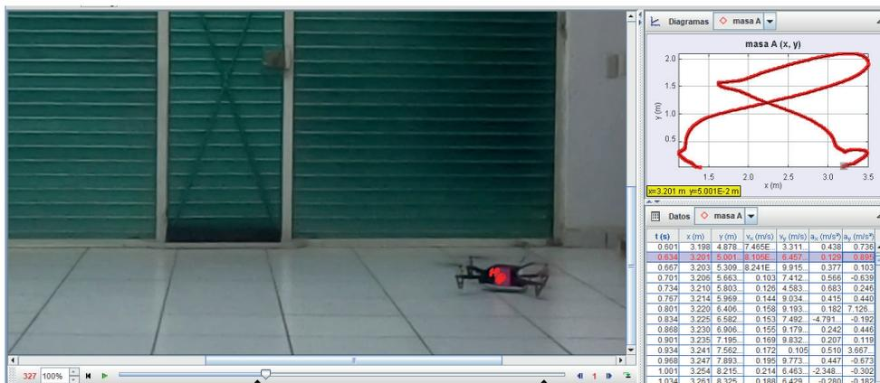
Figura C.21: Observación y análisis de movimiento del dron desde *Tracker*.
