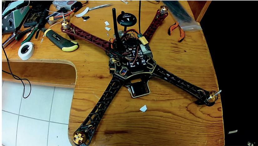
Figura 3.5: Dron tipo cuadrotor, ensamblado.
