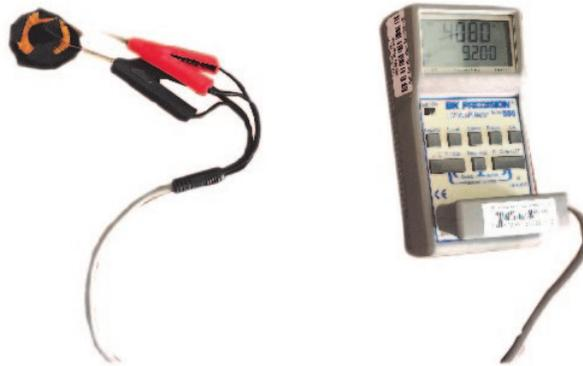
Figura 4.9: Medidor de inductancia.
