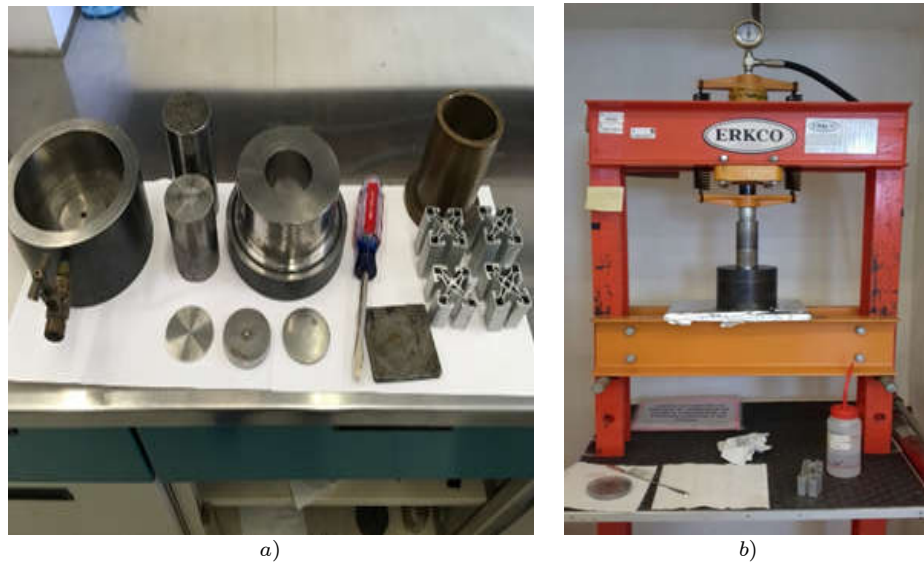
Figura IV.5. a) Accesorios para hacer blancos. b) Configuración de los accesorios colocados en la prensa hidráulica.
