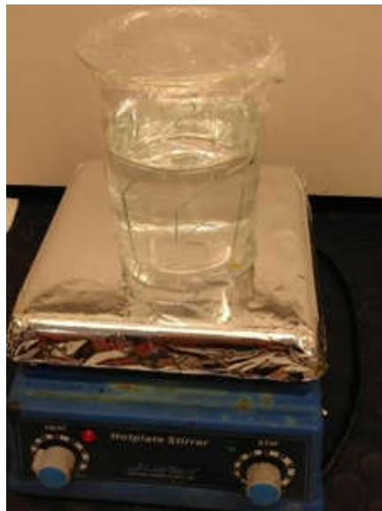
Figura IV.3. Ebullición de substratos en mezcla de agua con \text{HNO}_3 .
