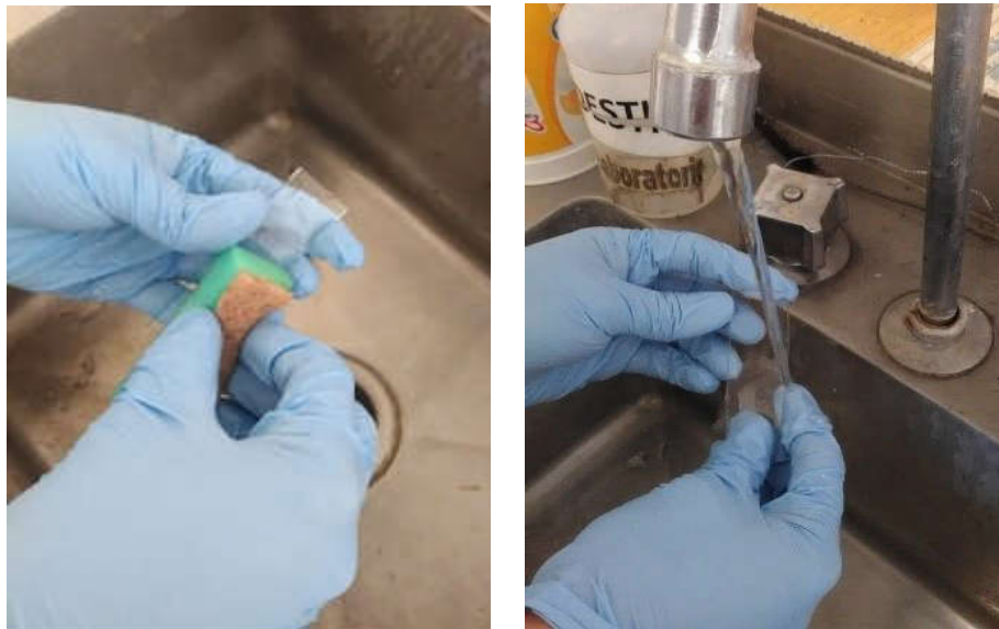
Figura IV.1. Lavado de sustratos de vidrio con agua común y jabón líquido.
