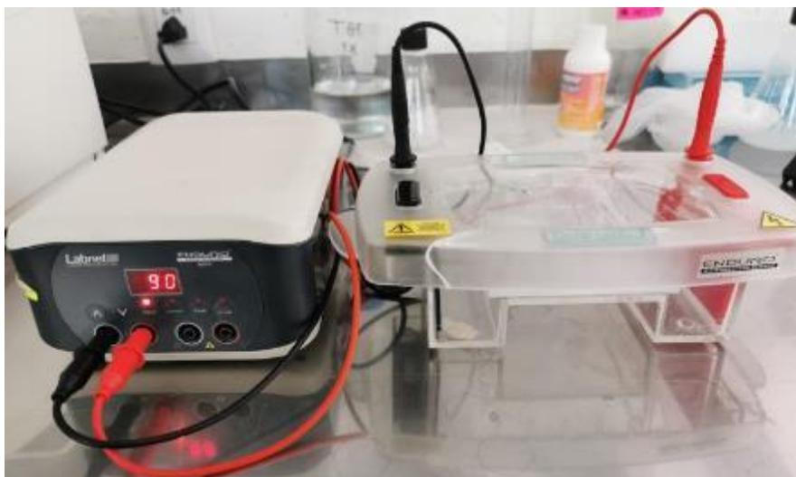
Figura 11. Unidad de electroforesis utilizada para la generación de los geles de agarosa en las pruebas de biología molecular.
