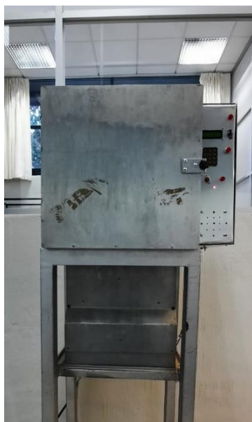
Figura 13. Secador de charolas giratorias.
