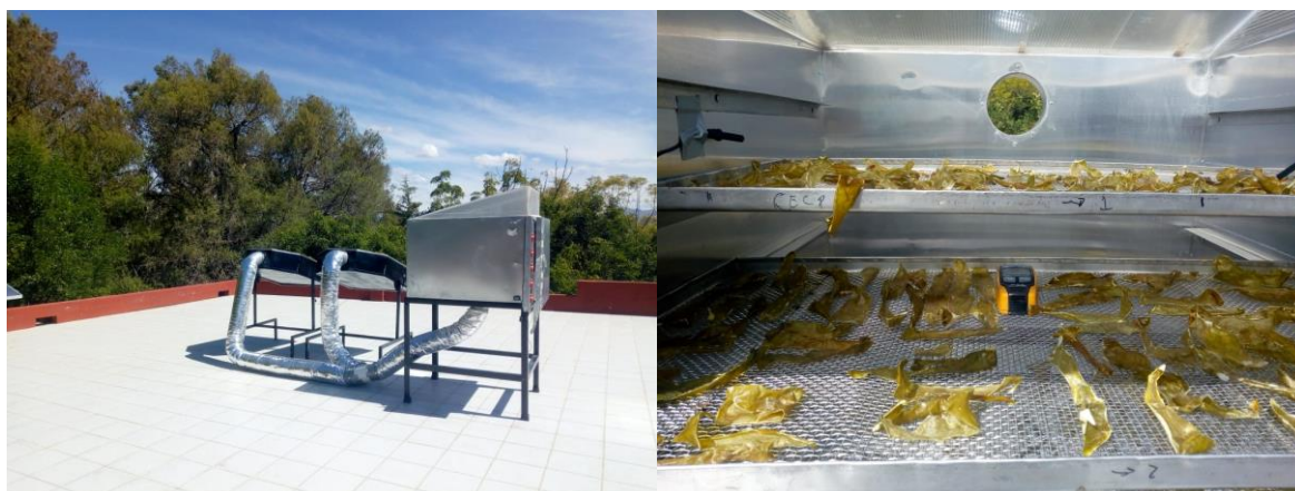
Figura 14. Secador solar mixto (izquierda) y cámara de secado con muestras de chile de agua ( C. annuum L.) (derecha).
