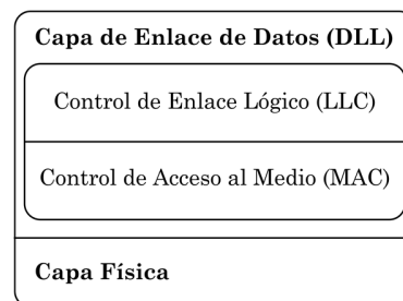
Figura 4.14. Capas del protocolo FlexRay (González Salinas, 2008).
