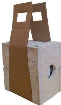
Como se observa en la Figura 52, se generó un segundo modelo que incorpora ranuras en donde se ensamblarán las dos caras que conforman a la cintilla. Se puede observar que conserva la silueta trapezoidal y se integran asas para su manejo, sin embargo, se observó que se tenían desgarres en la cintilla al utilizar las asas y transportar el empaque, por lo
