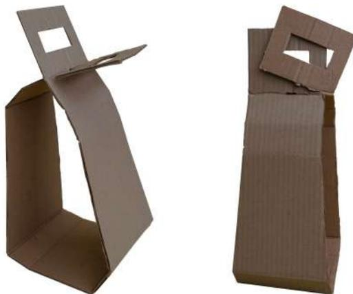
Como se presenta en la Figura 53, se elaboró un tercer modelo de cintilla, se realizaron cambios en cuanto a su forma base, uno de los lados conservó la forma trapezoidal mientras que la forma del lado contrario cambio a un perfil rectangular. Además, a un lado de la cara rectangular se integró una ranura en donde se introducirá el lado trapezoidal, sin embargo, como se observa en la Figura 53, se obtuvieron fallas por rotura al momento de levantar la carga.
