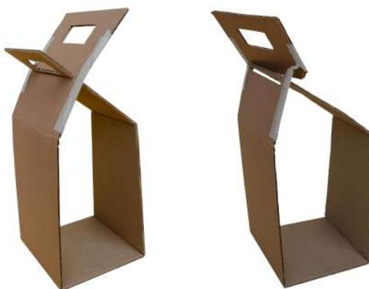
Como se muestra en la Figura 54, se realizaron mejoras adicionales en el diseño de la cintilla, en un cuarto modelo se optó por conservar la forma trapezoidal original, se agregó una pestaña y una ranura para garantizar el cierre del sistema. Este diseño permitió cargar
