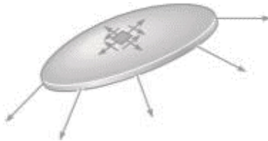
Figura 22.- Distribución de esfuerzos supuesta en recipientes a presión de pared delgada (Beer, 2017).
