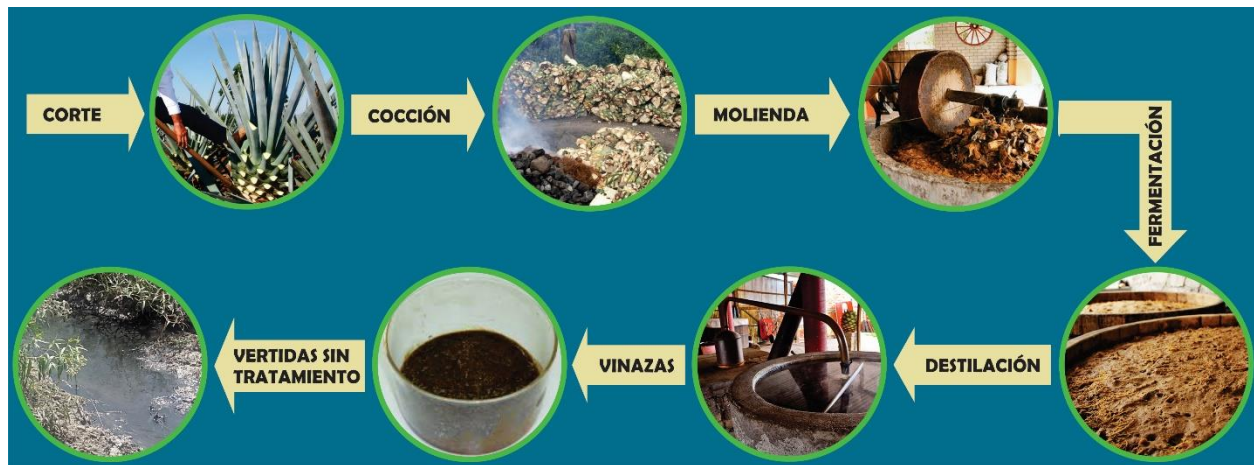
Figura 4.- Proceso de producción de mezcal y obtención de vinazas. Fuente: Elaboración propia.
