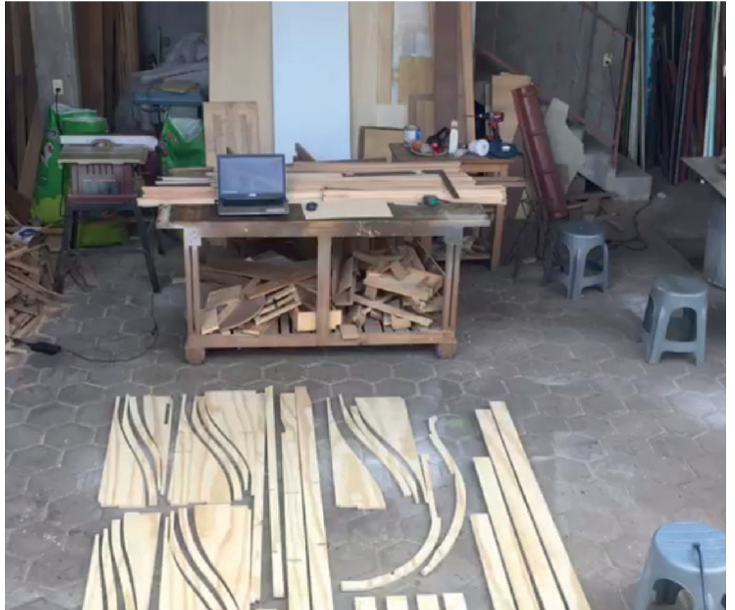
Imagen 5.54 Piezas estructurales de barra cortadas con proveedor CNC.
