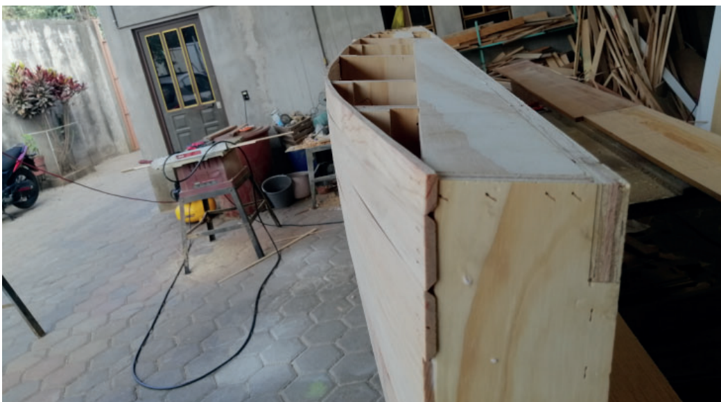
Imagen 5.57 Toda la página. Proceso de colocación de tiras sobre estructura. Las costillas de la estructura determinan la curvatura final y la vista del objeto.
