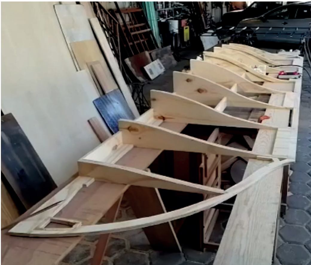
Imagen 5.55 Arriba y abajo. Armado de estructura principal de "canoa" con piezas cortadas en CNC. Dicha estructura proporcionará las curvas deseadas para lograr la apariciencia real de una embarcación.
