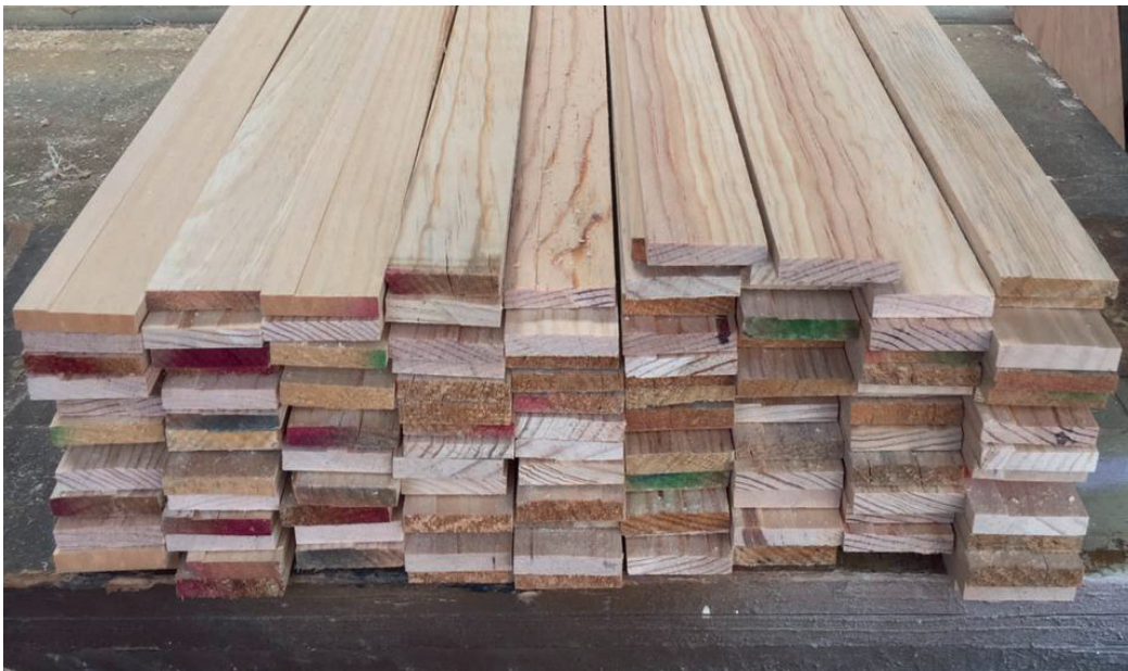
Imagen 5.53 Habilitado de tiras a medida para construcción de canoa.
