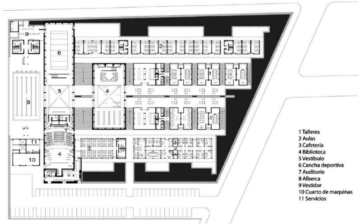
Figura 7. Planta arquitectónica del centro de invidentes y débiles visuales. Fuente: recuperado de: archdaily.mx/mx/609259/centro-de-invidentes-y-debiles-visuales-taller-de-arquitectura-mauricio-rocha .
