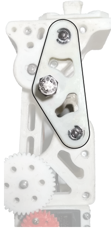
Figura 5.20: Tornillo que ajusta el sistema de bloqueo.
