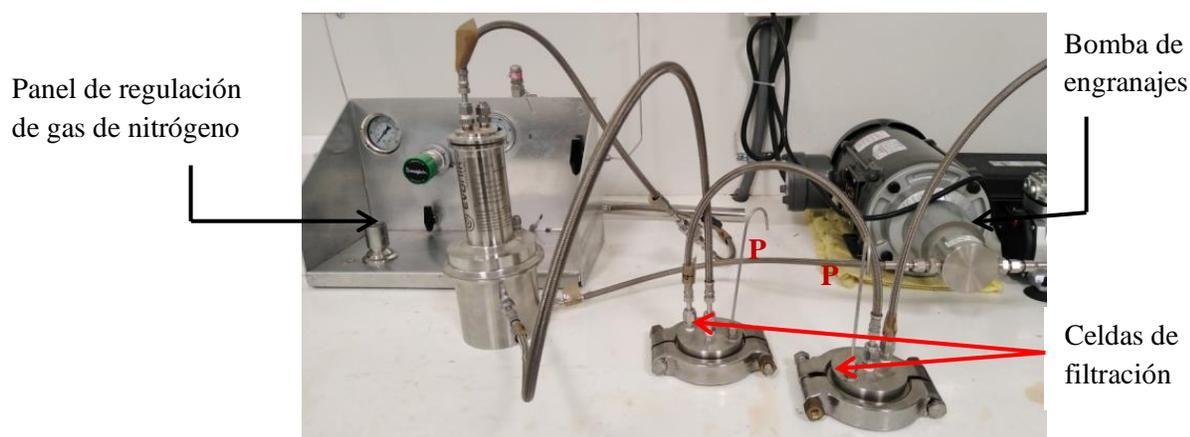
**Figura 20.** Equipo de filtración por membranas de ósmosis inversa (METcell Cross-Flow System), usando la configuración de modo de flujo tangencial. P, colección del permeado
