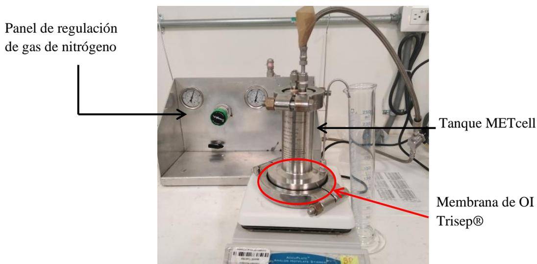
**Figura 17.** Sistema de filtración de ósmosis inversa METcell Cross-Flow System configurado en el modo de flujo normal usando una membrana de OI Trisep®
