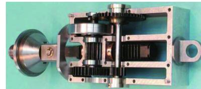
(a) Esquema del modelo mecánico del inersor de piñón-cremallera [35].
