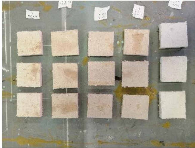
Figura 36. Probetas cortadas a la medida que establece la norma para esta prueba (Elaboración propia).
