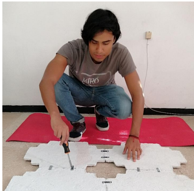
Figura 76. Colocación de pletinas al reverso de los módulos por el usuario 1 (Elaboración propia).
