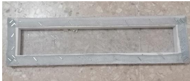
Figura 22. Molde terminado para la probeta utilizada en el ensayo de flexión (Elaboración propia).
