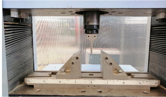
Figura 30. Mordazas colocadas y listas en la máquina universal de esfuerzos para la prueba de flexión (Elaboración propia).
