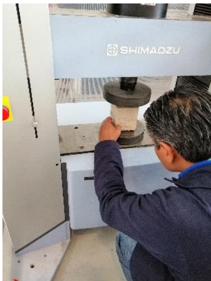
Figura 34. Colocación de la probeta en la máquina universal de esfuerzos (Elaboración propia).
