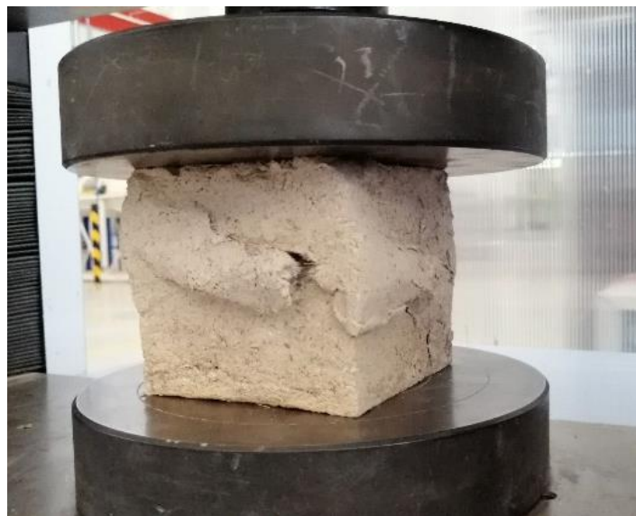
Figura 35. Ruptura del material debido a la carga aplicada, lo cual indica el fin de la prueba (Elaboración propia).
