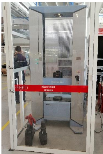
Figura 28. Máquina universal de esfuerzos (Elaboración propia).
