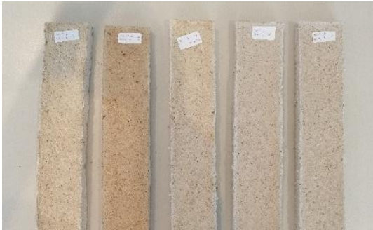
Figura 26. Probetas finales para la prueba de flexión (Elaboración propia).
