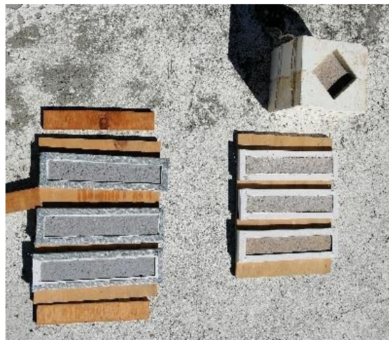
Figura 25. Proceso de secado de las probetas (Elaboración propia).
