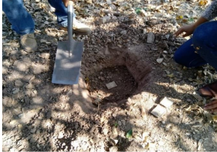
Figura 70. Probetas siendo enterradas (Elaboración propia).
