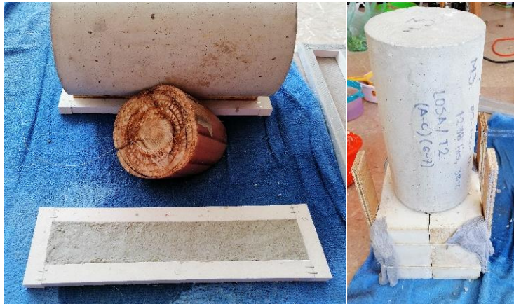
Figura 24. Aplicación de presión para compactar las probetas y retirar el excedente de agua (Elaboración propia).
