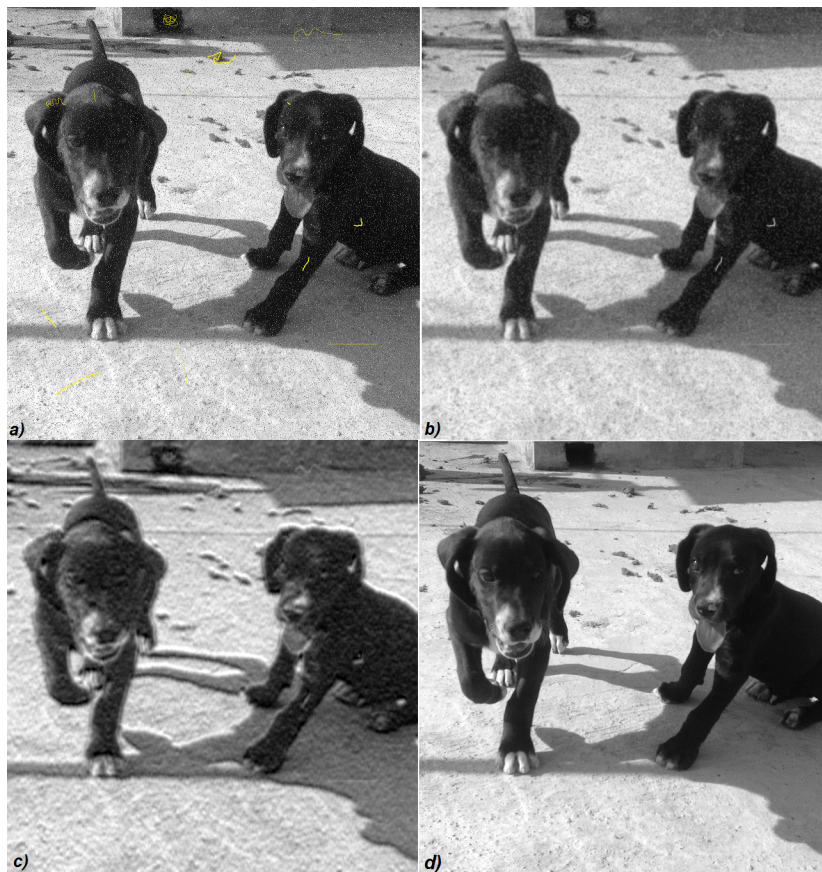
Figura 3.4: a) imagen digitalizada, con error de captura de tipo sal y pimienta y dominios perdidos. b) y c) imágenes restauradas por el método de solución, con distinto número de iteraciones. d) imagen objetivo. Fuente: Elaboración propia.
