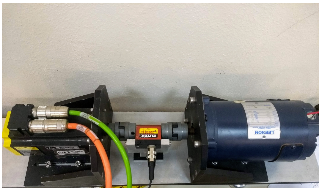
Figura A.10: MSIP empleado (izquierda), sensor de carga (centro) y motor de CD usado como carga (derecha).
