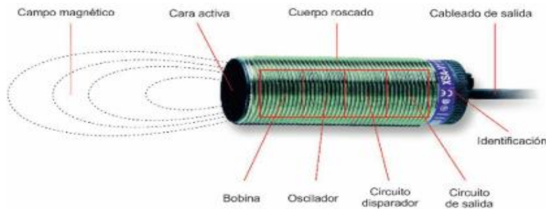
Figura 9: Componentes del sensor de proximidad inductivo.
