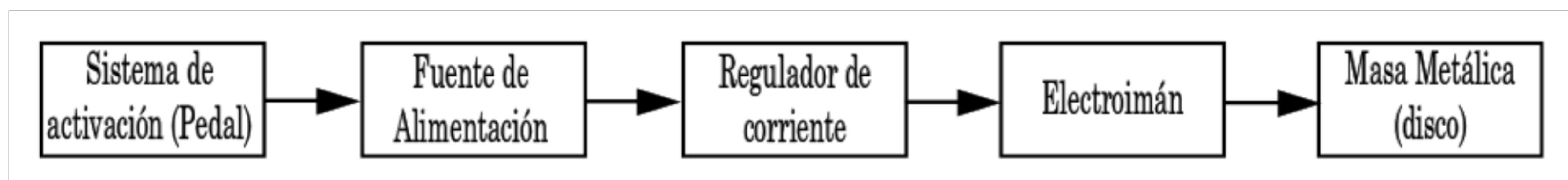
Figura 3.4. Sistema en serie del freno electromagnético (simplificado) (Elaboración propia).
