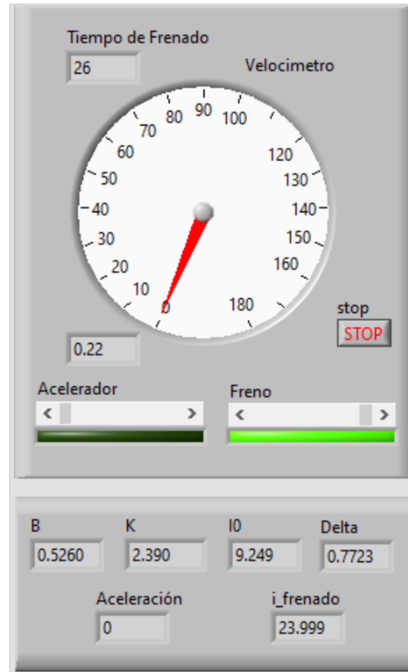
Figura 4.44. Prueba 2. B=0.526 T; t=26 seg (Elaboración propia).
