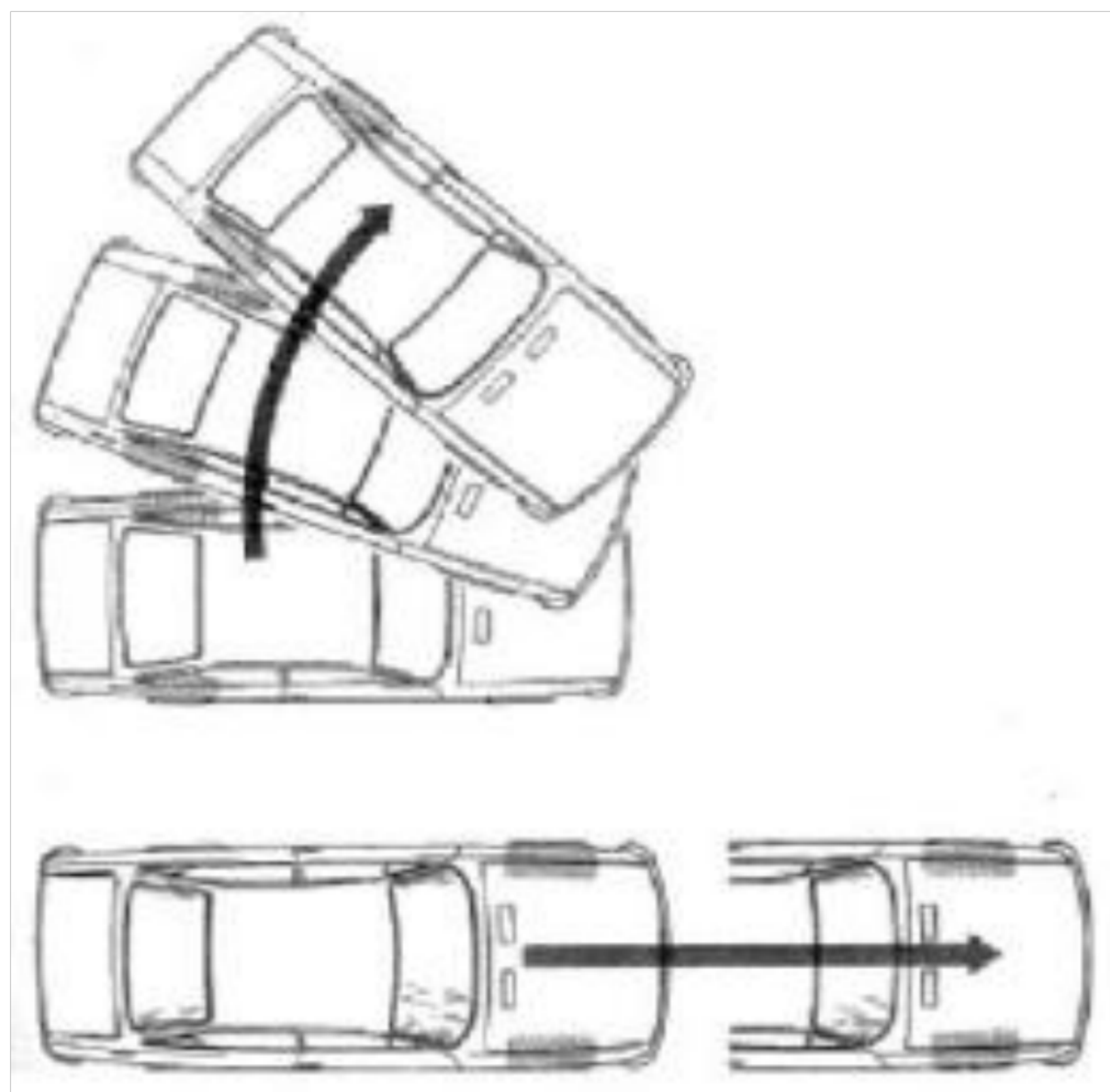
Figura 2.10. Deslizamiento por bloqueo de las ruedas traseras (Criado Ocaña, 2012).
