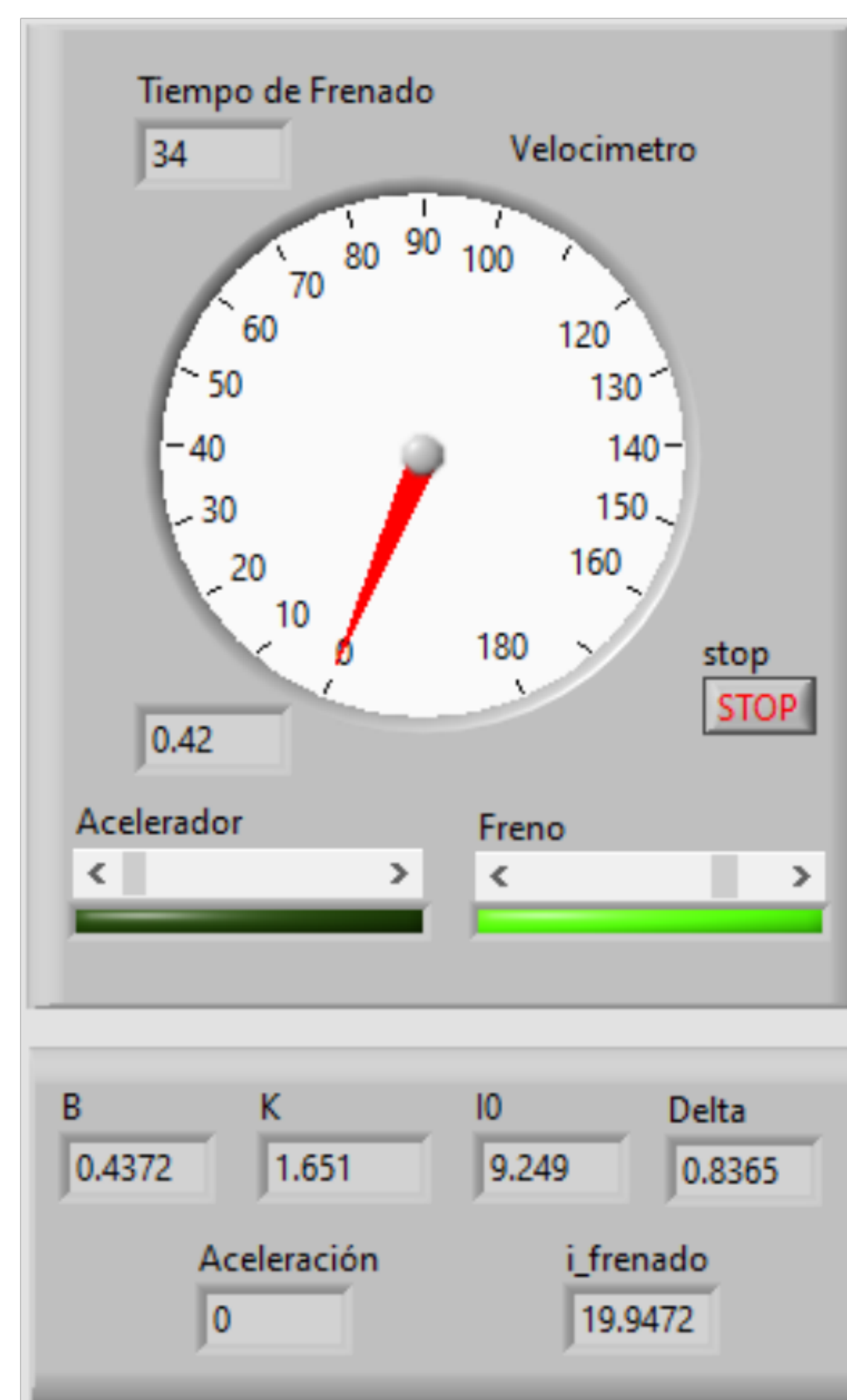
Figura 4.42. Prueba 1. \mathbf{B}=0.437\text{ T} ; t=34\text{ seg} (Elaboración propia).
