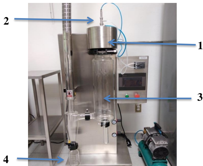
Figura 15. Componentes principales de un secado por aspersión: (1) sistema de calefacción, (2) sistema de atomización, (3) cámara de secado, (4) sistema de recolección de polvos.
