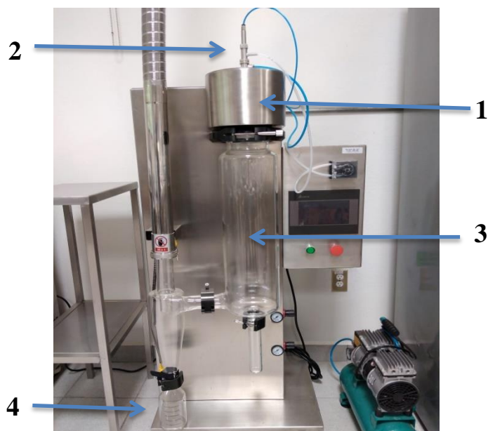
Figura 9. Componentes principales de un secado por aspersión: (1) sistema de calefacción, (2) sistema de atomización, (3) cámara de secado, (4) sistema de recolección de polvos.
