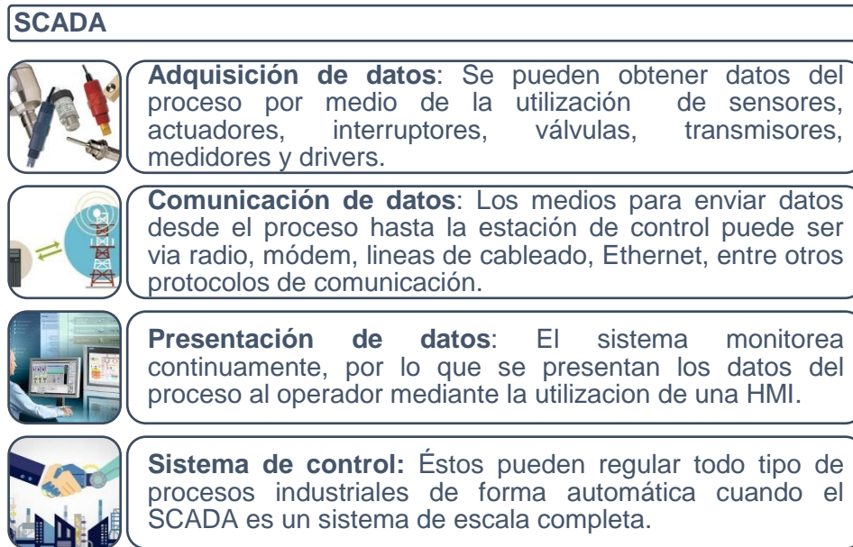
Figura 2. Funciones del sistema SCADA
