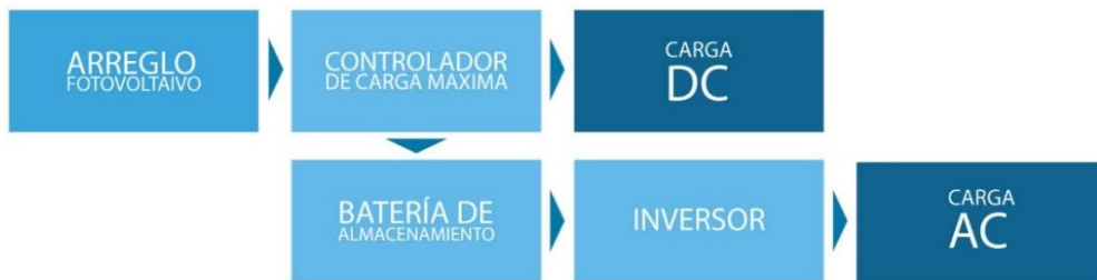
Figura 13 Diagrama esquemático de un sistema autónomo. Elaboración propia.
