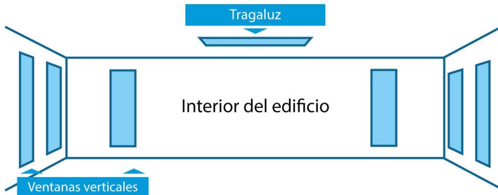
Figura 7 Utilización de vidrio fotovoltaico en tragaluz y ventanas verticales para brindar iluminación al interior del edificio. Fuente: propia con información del libro "Solar Energy Engineering"
